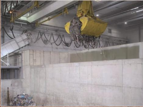
Mit Brandmeldeanlage verknüpft: Im Brandfall wird ein Steuerimpuls an den Kran gesendet, der sich dann automatisch aus dem Gefahrenbereich wegbewegt.
