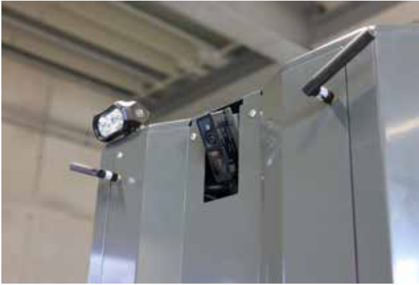
Die O3R-Kamera ist eine kombinierte 2D/3D-Kamera zur Umfelderkennung.
