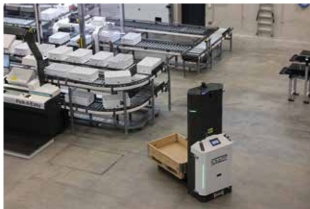
Das ‚Open Shuttle Fork‘ ist ein autonomer mobiler Roboter (AMR) zum Transport von handelsüblichen Paletten, Gestellen und Sonderladungsträgern.
