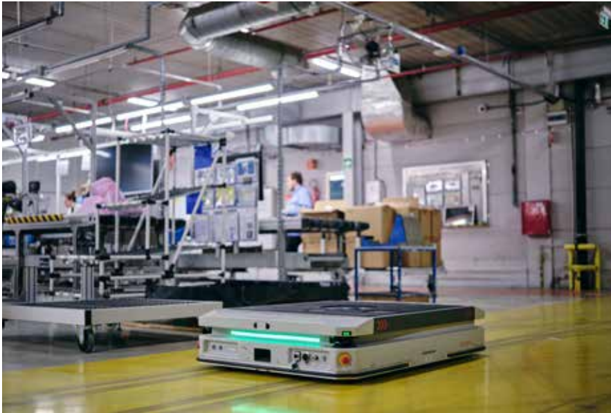
Die autonomen mobilen Roboter übernehmen den innerbetrieblichen Transport und entlasten Mitarbeitende von manuellen Tätigkeiten.
