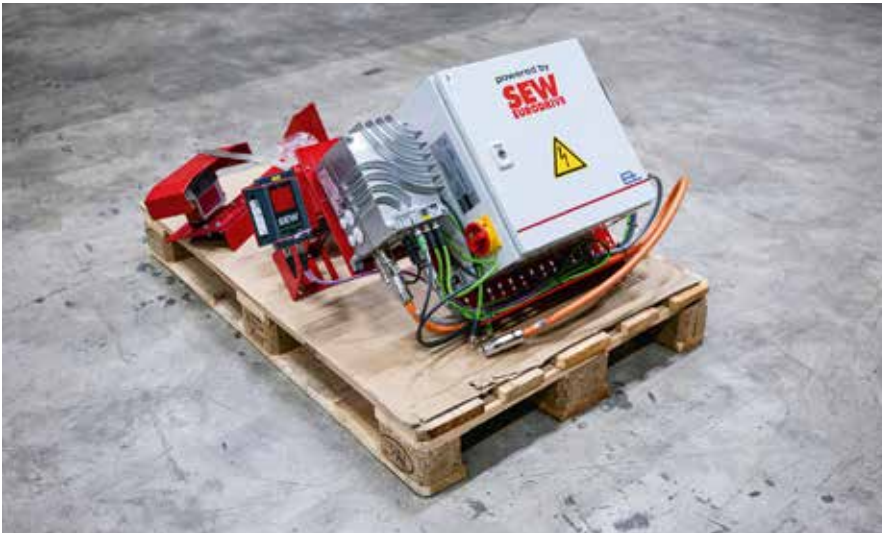
Für den reibungslosen und effektiven Umbau wurden alle neuen Komponenten vormontiert, verkabelt und auf einer Palette als Set für ein EHB Fahrzeug bereit gestellt.
