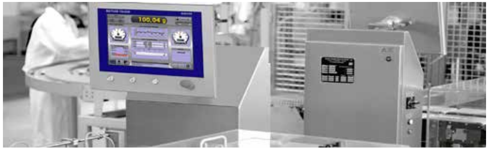
Die Kontrollwaage überwacht das Produktgewicht und kann die Abfüllanlage automatisch nachregeln, wenn sich Abweichungen vom Sollwert abzeichnen.
