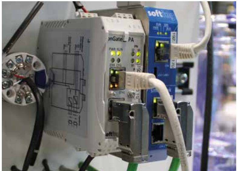
Das Gateway bindet bestehende Profibus-PA-Segmente direkt in eine Profinet-Architektur sowie in Engineering- und Asset-Management-Systeme ein.
