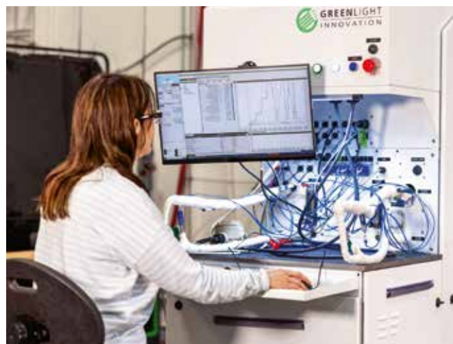
Die Elektrolyseur-Teststation von Greenlight dient der Bewertung und Validierung von Leistung, Langlebigkeit und Effizienz.
