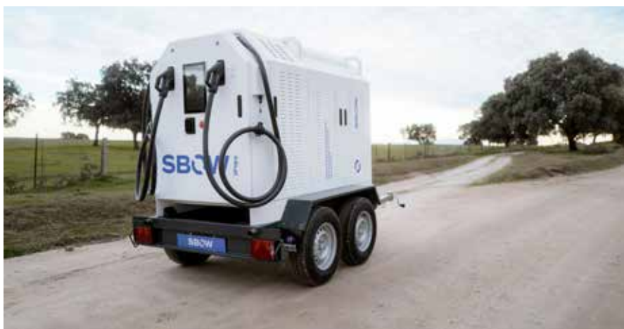
Der mobile Batteriespeicher kombiniert Energiespeicherung und Schnellladen in einer transportablen Lösung abseits bestehender Netzinfrastruktur.
