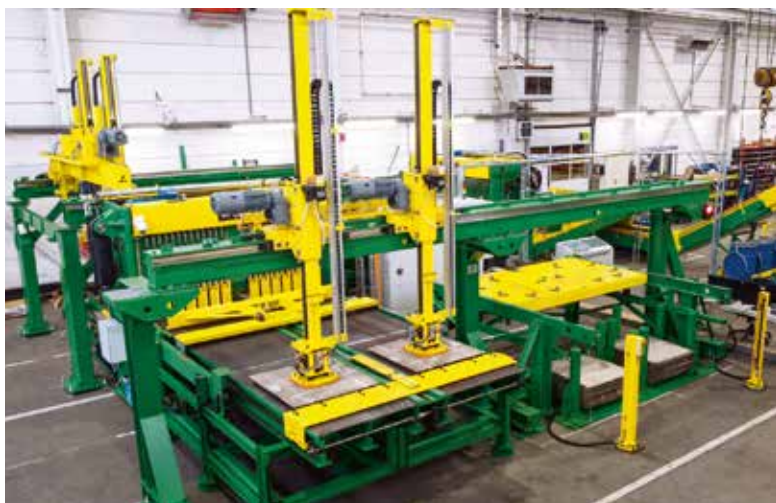
Überblick über die Nickelschneideanlage mit der Eingangsposition für die Nickelkathoden vorn und dem Ausgang der geschnittenen Nickelblöcke zu den Sammelbehältern rechts.
