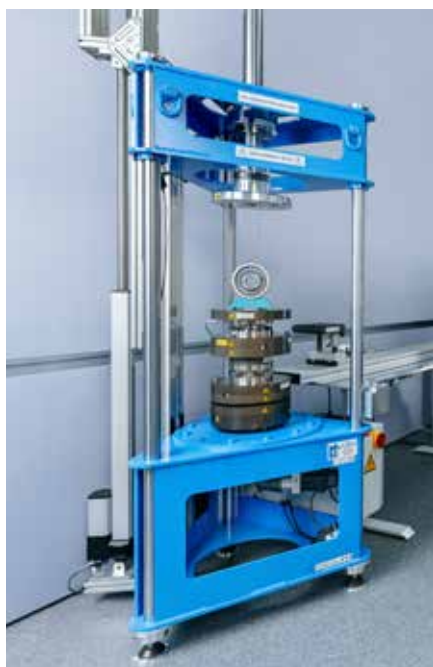
Die CEH-Kalibriereinrichtung mit dem Galaxie-Getriebe ist aktuell in der modernen Calibration Factory von Testo Industrial Services im Einsatz, wo sie für akkreditierte Kalibrierdienstleistungen und anspruchsvolle Kundenprojekte genutzt wird.
