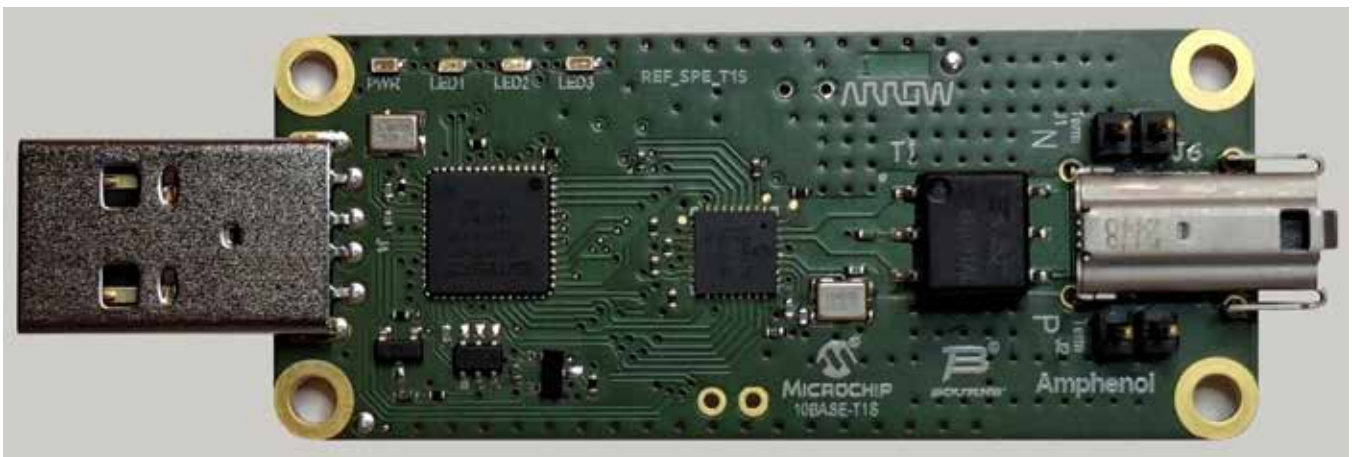
Das Referenzdesign 10BASE-T1S REF_SPE_T1S in Zusammenarbeit mit Microchip Technology, Bourns und Amphenol unterstützt Ingenieure bei der Implementierung von Single Pair Ethernet.
