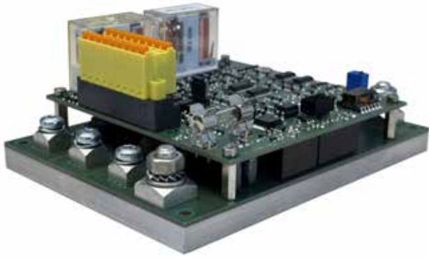
Der Halbleiter-Sicherheitsswitch SES ermöglicht Laseranlagen, mit Taktzyklen bis Cat. 4/Performance Level e zu betreiben.
