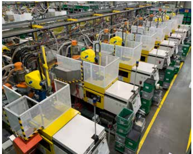
Ganzheitliches Monitoring: ITW überwacht nicht nur den Strom für die Maschinen, sondern auch Prozessfaktoren wie Kühlleistung und Druckluft pro Kubikmeter.
