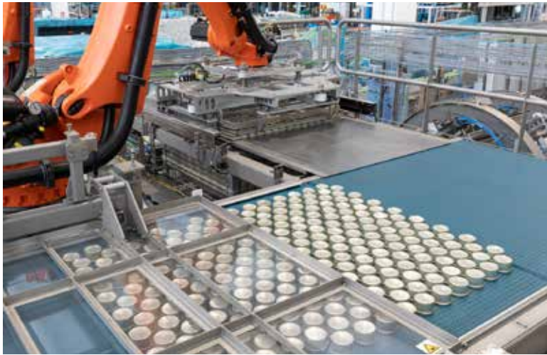
Kuka-Roboter befördern 1200 Dosen pro Minute auf das Fließband.
