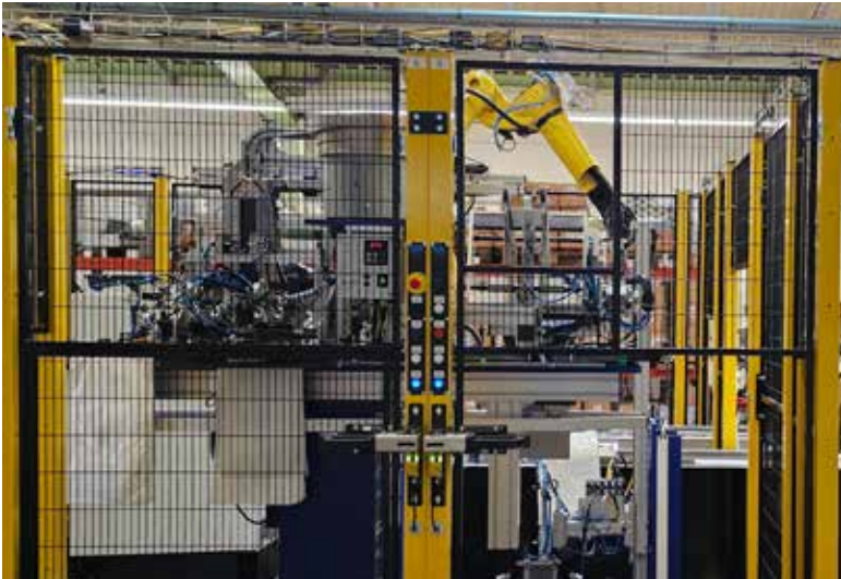
Die Anbindung der NOT-HALT Taster, Türzuhaltungen und Lichtgitter wurde über aktive Verteiler ASi und aktive Verteiler ASi Safety umgesetzt, die platzsparend am oberen Rand der Roboterzelle über ein einziges ASi Profilkabel an das ASi Gateway im Schaltschrank angeschlossen wurden.
