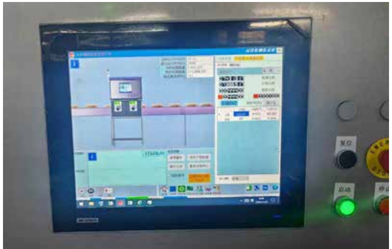
Das Bildverarbeitungssystem überwacht den Prozess der Nudelkontrolle.
