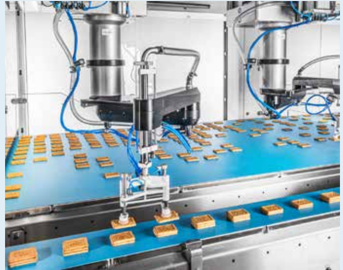
Mit den Scannerinformationen nehmen Pick-and-Place-Roboter die gewünschten Produkte auf.
