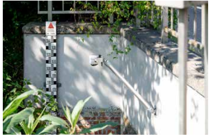
Alt vs. neu – Pegellatte und moderner Radarsensor Vegapuls Air 41.
