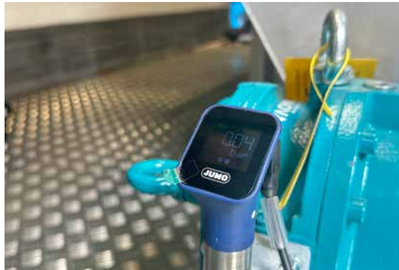
Sensoren von Jumo erfassen kontinuierlich Druck, Temperatur und Füllstände entlang des Prozesses.
