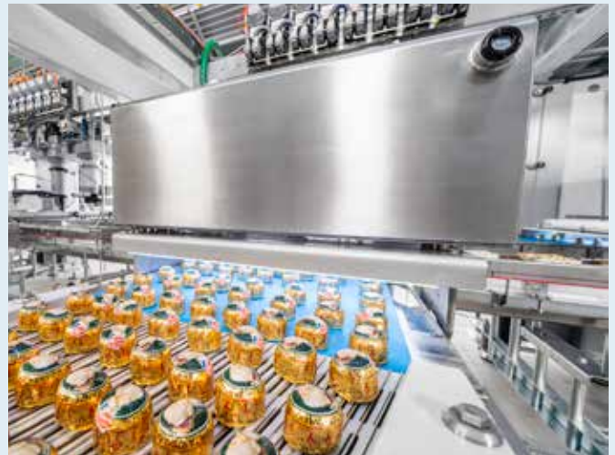
2D-Scanner (obere Bildhälfte) fügen mehrere, ein Pixel große Bilder zu einem zweidimensionalen Flächenbild zusammen.
