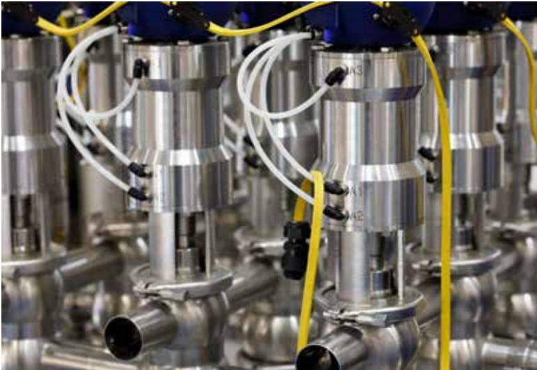
Ventilansteuerungen mit AS-Interface sind seit vielen Jahren Standard in der Prozessautomation.
