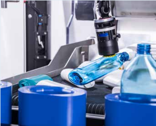
Der Cobot tog.519 von Schubert greift ungeordnete Produkte aus unterschiedlichen Winkeln.
