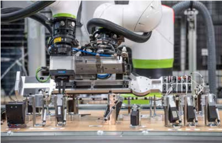
Die Geometrie der Steckverbinder gewährleistet eine wiederholgenaue Positionierung und eine prozesssichere Kontaktierung im Montageprozess.
