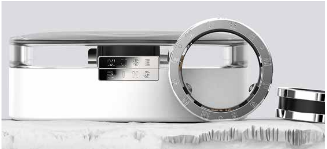
Im Ring sind ein Temperatursensor, ein 3D-Beschleunigungssensor, eine Gyroskop sowie eine einzige NFC-Antenne untergebracht.
