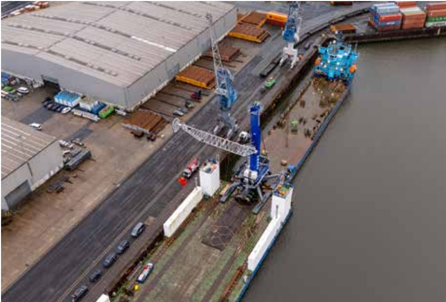
Der rund 440 Tonnen schwere Kran wurde auf dem Wasserweg vom Liebherr-Produktionsstandort in Rostock angeliefert.
