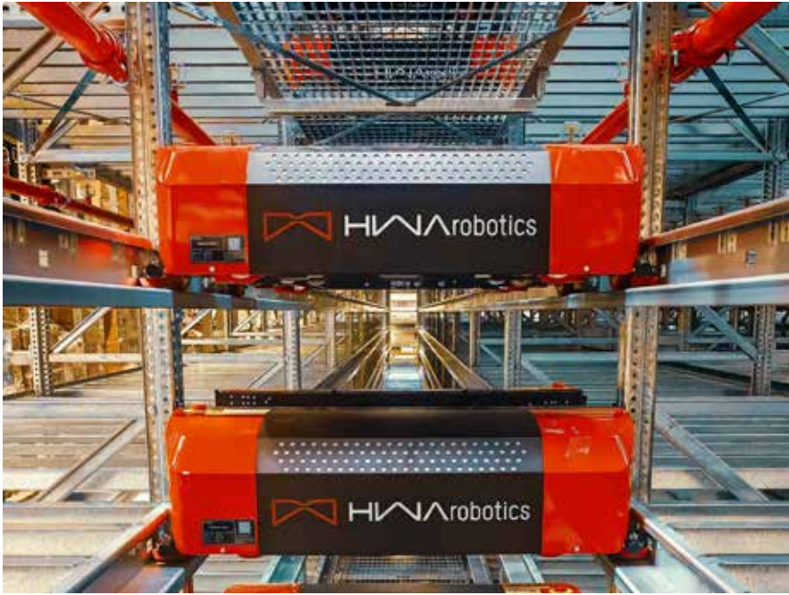
Zwei zentrale Lifte verbinden die einzelnen Regalebenen mit der Fördertechnik auf der Grundfläche.
