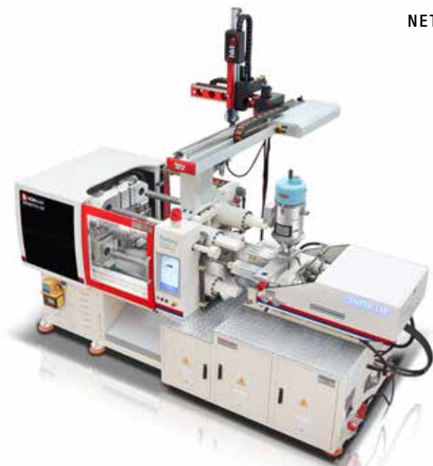
Die Zenith-Baureihe umfasst Maschinen mit dem innovativen hydraulischen Zwei-Platten-Schließsystem. Sieben verschiedene Modelle liefern zwischen 110 und 1.000t Schließkraft.
