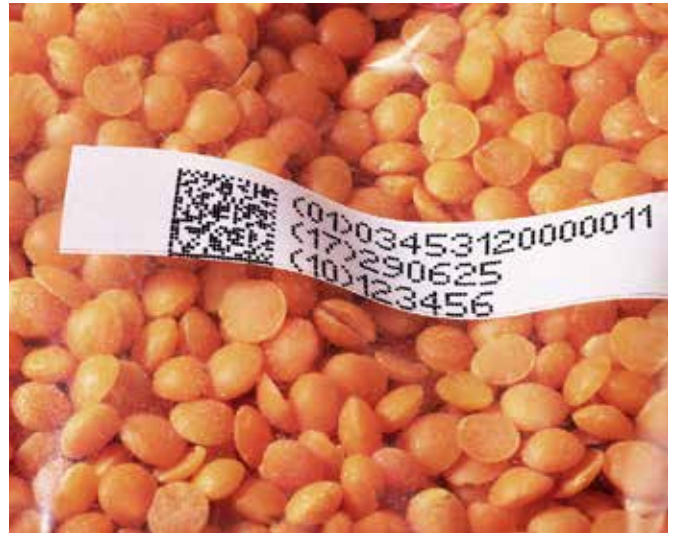
Eine intelligente Lösung für maximale Lesbarkeit des Codes auch auf transparenten Verpackungen: zuerst der Hintergrunddruck, dann der Code – alles in einem nahtlosen Prozess mit CIJ.
