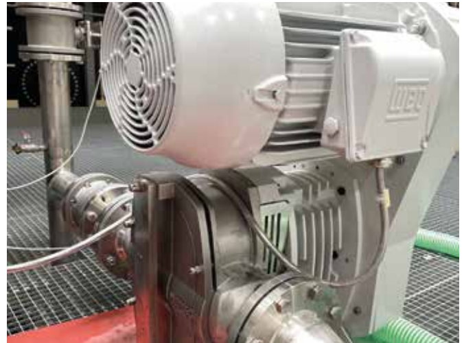
Die Tornado-Pumpe von Netzsch ist eine druckfeste Drehkolbenpumpe, die selbst abrasive und feststoffhaltige Flüssigkeiten schonend und präzise fördert.
