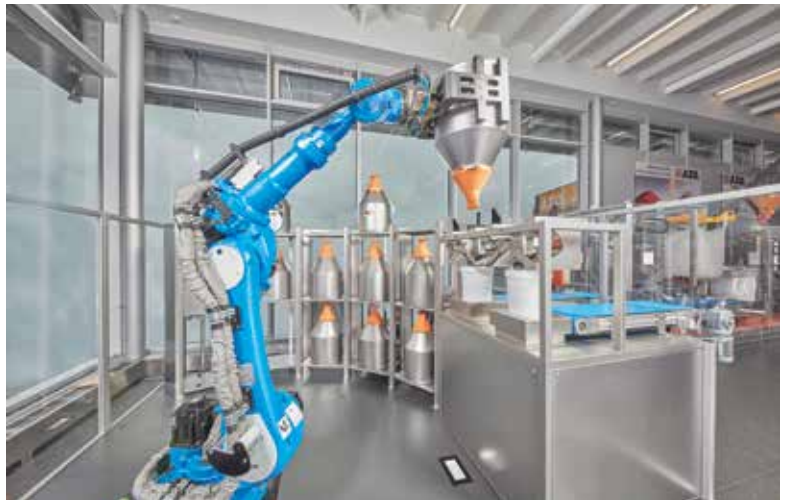
Roboterbasierte Rohstoff-Automation: der Rolog von Azo mit den DLEs und dem orangen Dosierorgan eDos.
