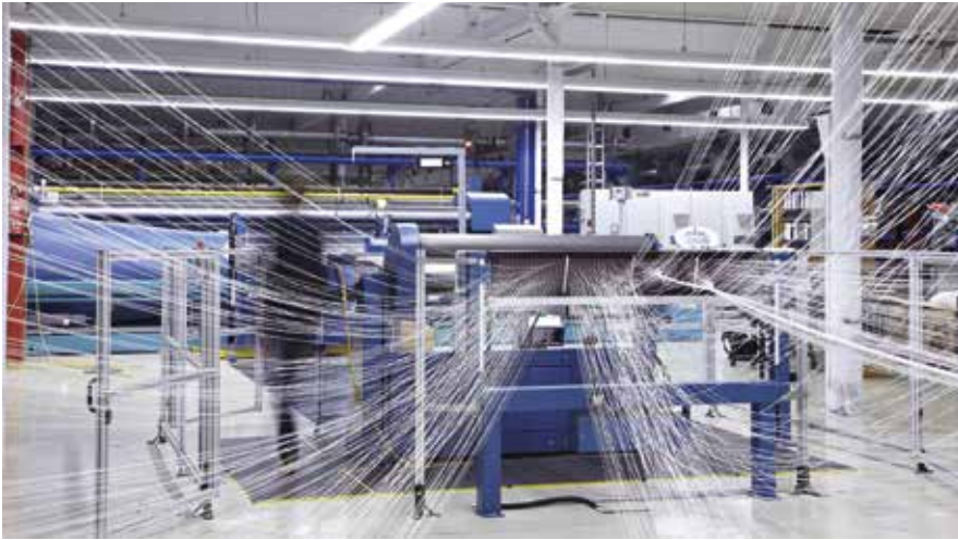
Das Herz der Produktion sind die Luftwebmaschinen, in denen mithilfe komplexer Technologien das auf die jeweilige Kundenanforderung spezialisierte Gewebe entsteht.
