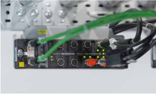
Turck hat sein I/O-Modul TBEN-LL-4RM zur Steuerung von CAN-Rollenmotoren und zur Digitalisierung der Förderstrecken exakt auf die Anforderungen von SSI Schäfer zugeschnitten.
