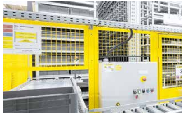
In der neuen Generation seiner Förderanlagen nutzt SSI Schäfer die „Conveyor Control Unit“ CCU, ein von Turck entwickeltes CAN-I/O-Modul zur Steuerung der Trommelmotoren und Erfassung der Sensordaten.
