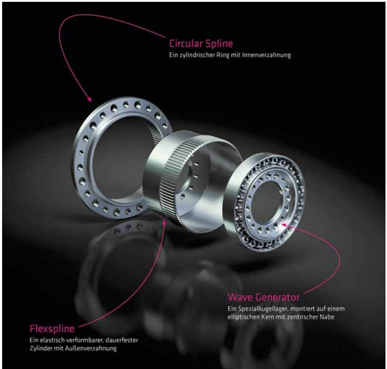
Harmonic Drive Funktionsprinzip
