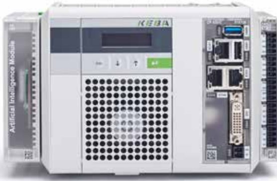
Das KI-Erweiterungsmodul wurde speziell für KI-Anwendungen im industriellen Bereich entwickelt. Keba bietet damit alle Werkzeuge, die zum Sammeln, Verarbeiten und Interpretieren von Daten benötigt werden.
