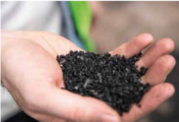
Im Pyrolyse-Reaktor wird ein Gemisch aus geschredderten Altreifen pyrolysiert. 5.000 t Gummigranulat, die Menge von etwa 7.500 t Reifen, werden pro Reaktor jährlich umgewandelt.
