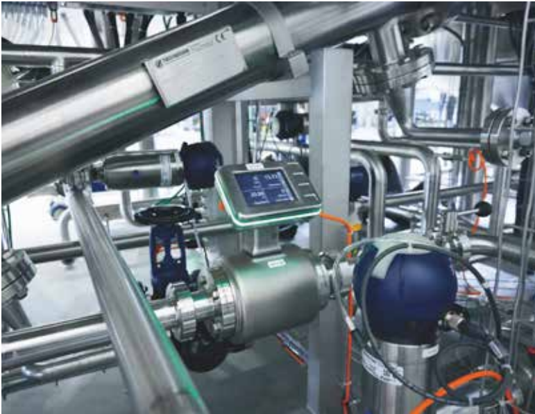
Der SM Foodmag erfasst mit Durchfluss, Leitfähigkeit und Temperatur drei wichtige Messgrößen an einer Messstelle.
