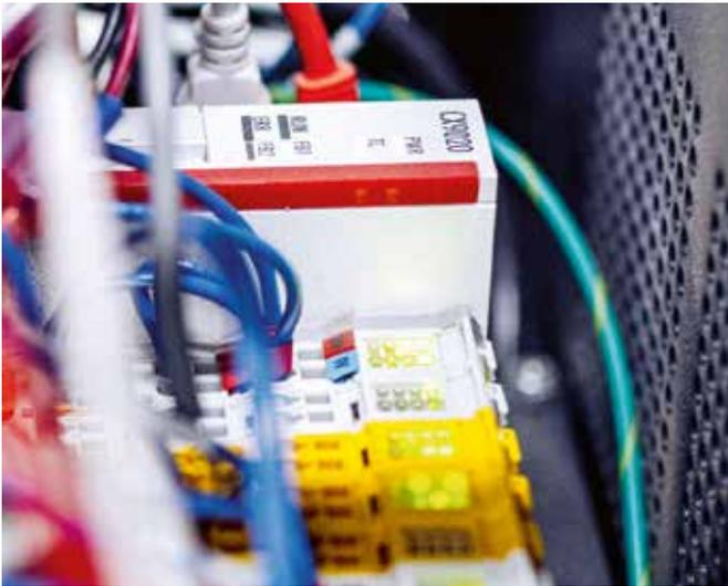
Jedes Kid-Modul von Flyhouse verfügt über einen Beckhoff Embedded-PC CX9020 mit EtherCAT- und TwinSAFE-Klemmen und kann sowohl im Verbund mit anderen Modulen als auch stand-alone eingesetzt werden.
