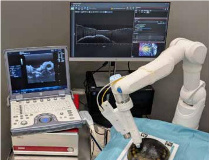
Der DLR MIRO ist ein vielseitig einsetzbarer Roboterarm für medizinische Anwendungen. Er kann aus der Ferne gesteuert werden oder den Chirurgen direkt am OP-Tisch assistieren. Das Bild zeigt das neue Setup zur automatischen und präzisen Untersuchung von Gewebe.
