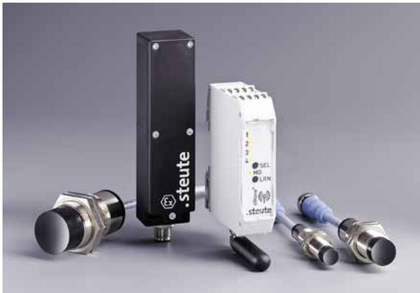
Das heißt: Die Induktivsensoren sind nicht wie bisher mit einem festen Schaltpunkt ausgestattet, sondern passen den Schaltpunkt automatisch und dynamisch an die jeweiligen Gegebenheiten an. Dazu gehört auch das Unterscheiden zwischen bündigem und nicht bündigem Einbau. Sogar an dynamische Veränderungen wie z. B. zunehmende Verschmutzung kann sich die Sensorik anpassen. Die Sensoren sind somit immer einsatzfähig und schalten nur dann, wenn die Situation bzw. der Bedienerwunsch es erfordert.
