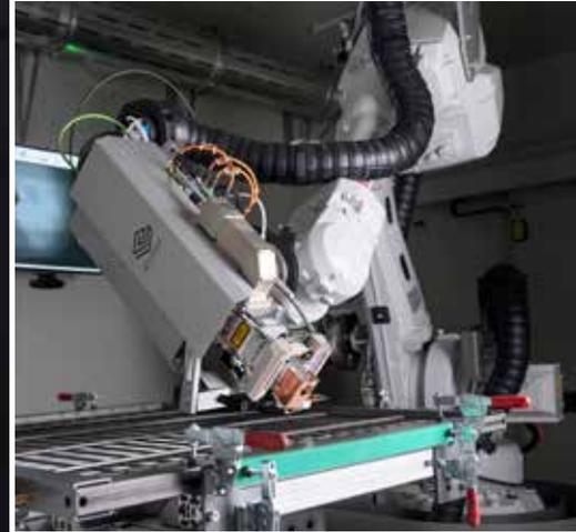
Die von der BLM Group neu entwickelte robotergestützte Laserschweißzelle LW-S ermöglicht das genaue und wiederholbare Schweißen einer Vielzahl verschiedener Materialien. Sie erzeugt robuste und kontinuierliche Schweißnähte, die keine Nachbearbeitungen erfordern. Die Anlage ist individuell konfigurierbar und kann mit unterschiedlichen Werkstückträgern ausgestattet werden – angefangen bei einfachen Schweißtischen über Spindeln bis hin zu neigbaren Drehtischen.
