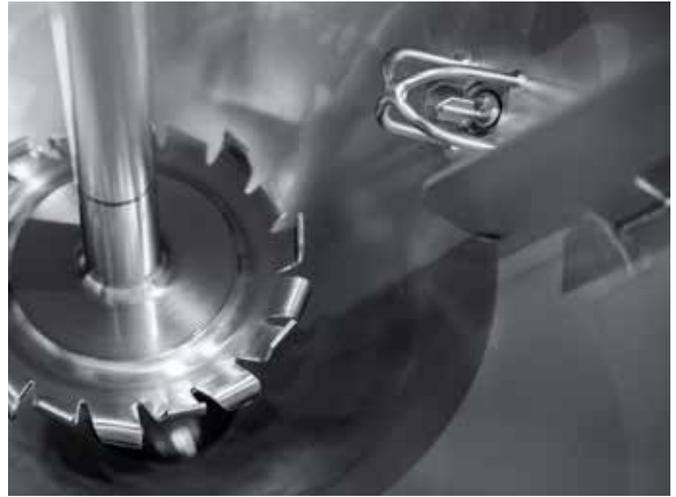
Das Hochgeschwindigkeitsrührwerk der Pulverlösestation übernimmt als erste von drei Stufen die Durchmischung und Auflösung der flüssigen und festen Zutaten.
