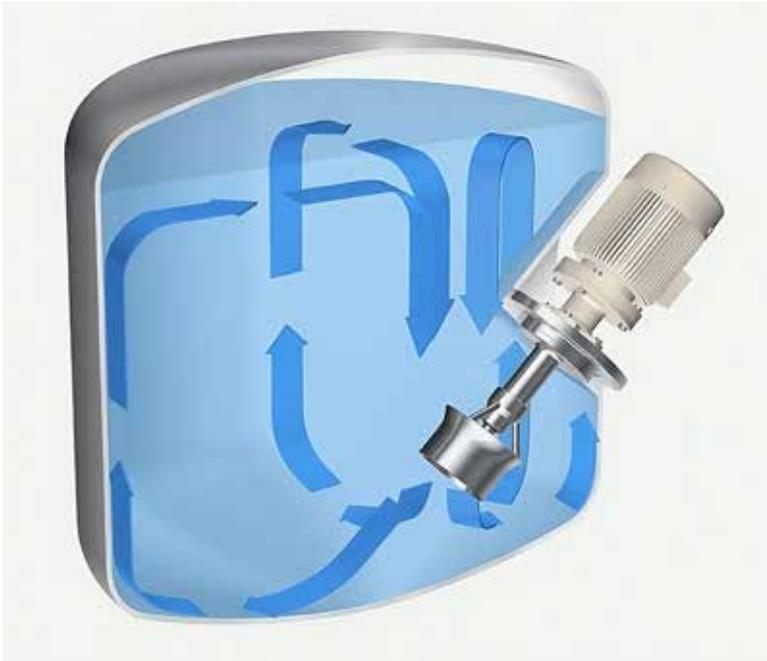
Leitstrahlmischer kombinieren die intensive turbulente Mikrovermischung im Mischkopf mit der laminaren Makrovermischung des restlichen Behälterinhalts. Weil die Mischzeiten bei einem Leitstrahlmischer je nach Produkt um bis zu 90 % reduziert werden, beträgt der Energiebedarf trotz zwei- bis dreifach höherer Leistung weniger als ein Drittel.
