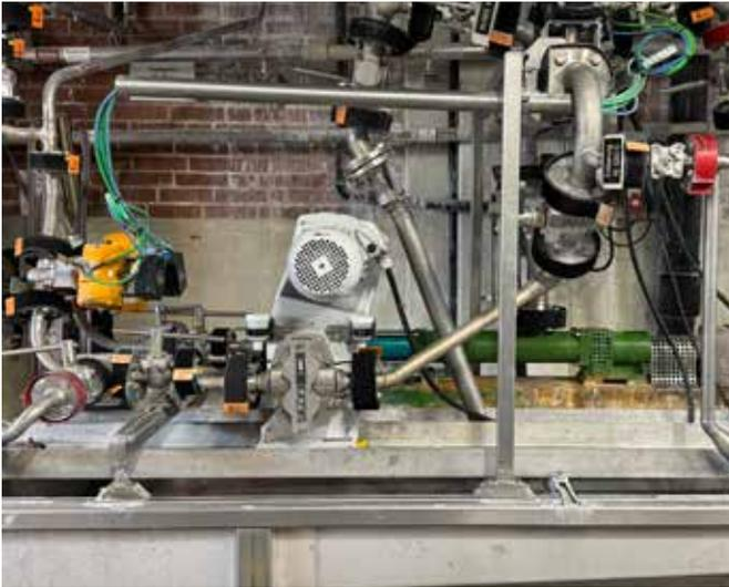
Pumpen- und Getrieberaum der Tornado T.Proc Drehkolbenpumpe sind einfach zugänglich.
