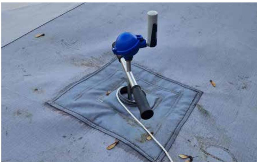
Das neue System nutzt eine halbdurchlässige Membran und Druckluftbelüftung, um hohe Temperaturen für eine zuverlässige Hygienisierung zu erzeugen.
