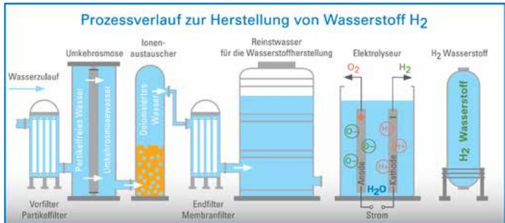
Prozess zur Wasserstoffproduktion: Das Reinstwasser ( $H_2O$ ) wird durch Elektrolyse in Wasserstoff ( $H_2$ ) und Sauerstoff ( $O_2$ ) aufgespalten. Der Wasserstoff wird anschließend gesammelt, komprimiert oder für weitere Anwendungen aufbereitet.
