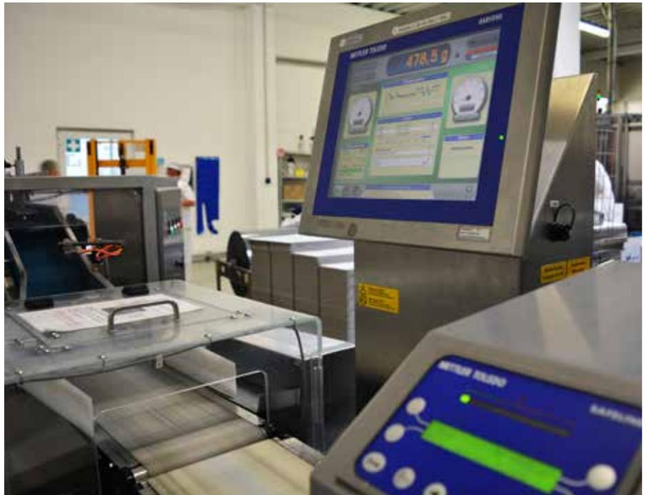
Kombinationseinheiten wie Kontrollwaagen mit integrierten Metalldetektoren oder Röntgeninspektion minimieren den Platzbedarf und maximieren Sicherheit und Effizienz.
