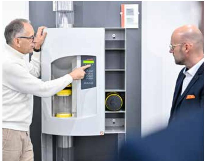
An den Einwurf- oder Entnahmestationen können die Rohrpostbüchsen versandt und auch wieder entnommen werden. Durch die Eingabe einer Codenummer landet die Büchse am richtigen Ziel.
