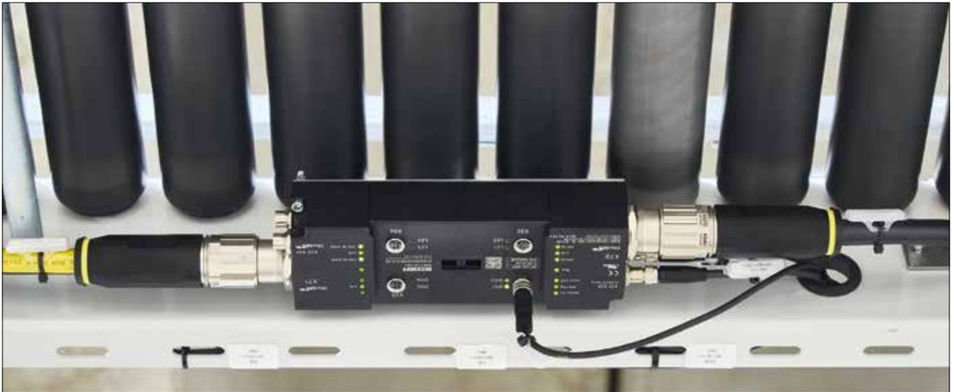
Intralogistik-Anlagen wie der zentrale Ringförderer bei Arvato profitieren besonders von der One Cable Automation: Power und Kommunikation werden an die kompakten MDR-Controller EP7402 über vorkonfektionierte Hybridleitungen effizient verteilt.
