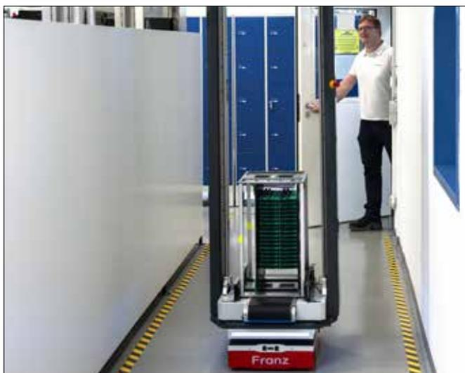
Seine mit 719 x 676 mm äußerst geringe Grundfläche ermöglicht es dem aufgabenspezifisch entwickelten, ESD-konformen autonomen Transportfahrzeug, auf engstem Raum zu navigieren, auch in gemeinsam mit Menschen genutzten Gängen.
