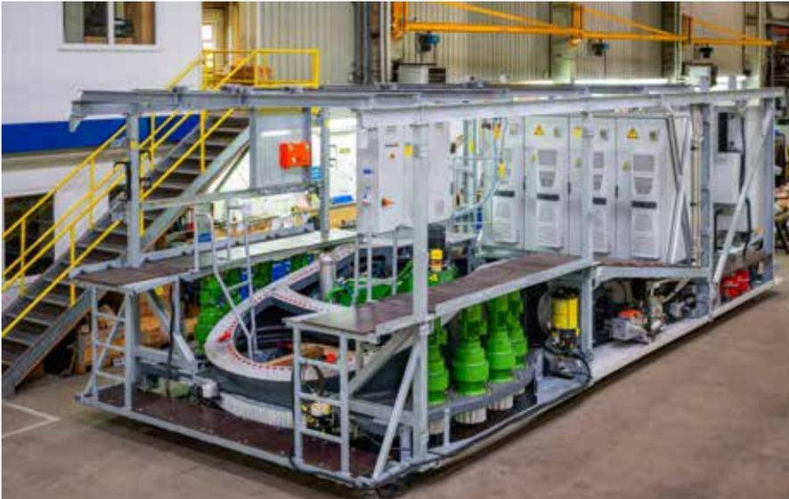
Die speziell für hohe Vibrationsbelastungen ausgelegten IS2 Schaltschränke mit integriertem Erdbebenkit und die leistungsstarken SACE Leistungsschalter bilden das Herzstück der Umrichtertechnik in der Gondel.
