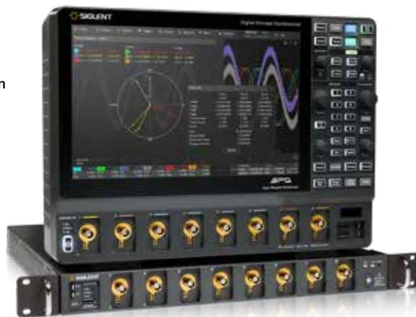
der standardmäßig große Erfassungsspeicher (insgesamt 2,5 Gpts) der SDS5000X-HD-Serie ermöglichen über alle Kanäle hinweg eine zeitlich akkurate Erfassung von kompletten Einschaltvorgängen in einem einzigen Messdurchlauf. Die vielen Messfunktionen unterstützen bei der Analyse und Dokumentation. Mehrfache Wiederholungen und die Gefahr, kritische Details zu verpassen, entfallen - ein erheblicher Effizienzgewinn für Entwicklungs- und Validierungsaufgaben.
