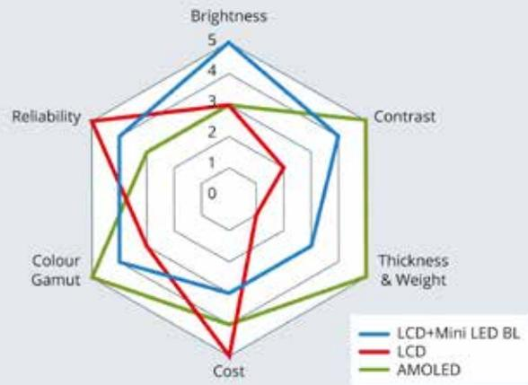
Einen guten Überblick über die Stärken und Schwächen eines Displays bietet die Darstellung in einem Netzdiagramm.
