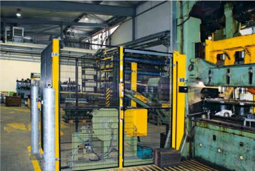
Im Rahmen der Modernisierung der Stufenpresse sollte die Steuerungstechnik aktualisiert und die vorhandenen Sicherheitseinrichtungen auf den neuesten technischen Stand gebracht werden.
