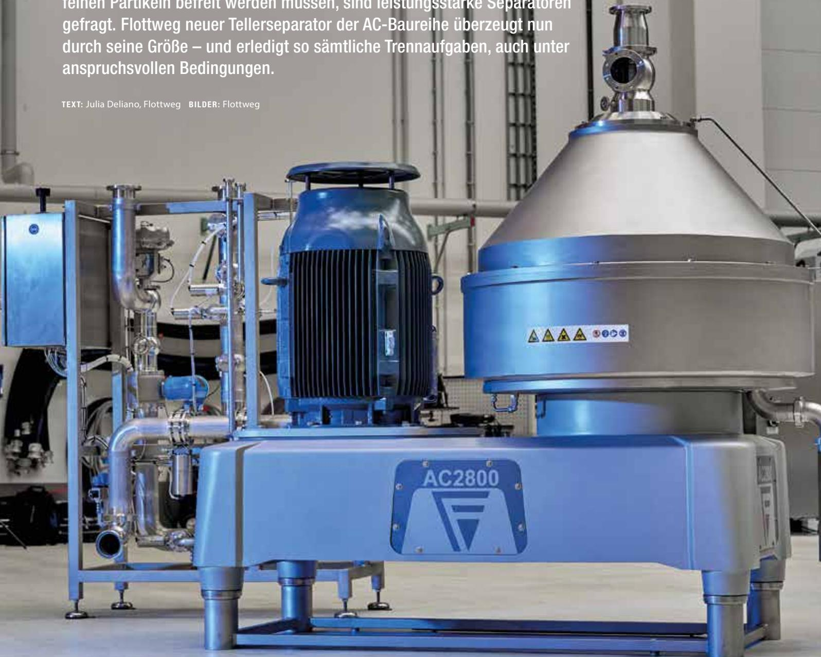
Flottwegs neuer Separator wurde gezielt auf die Anforderungen der Kunden konzipiert – um noch mehr Durchsatz zu ermöglichen. Mit Funktionen wie SoftShot-Entleerung und hydrohermetischer Abdichtung kombinieren sie Effizienz, Flexibilität und Prozesssicherheit.
