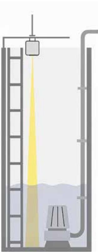
Durch die gute Fokussierung liefern Radarsensoren auch bei beengten Platzverhältnissen und Einbauten zuverlässige Messergebnisse.
