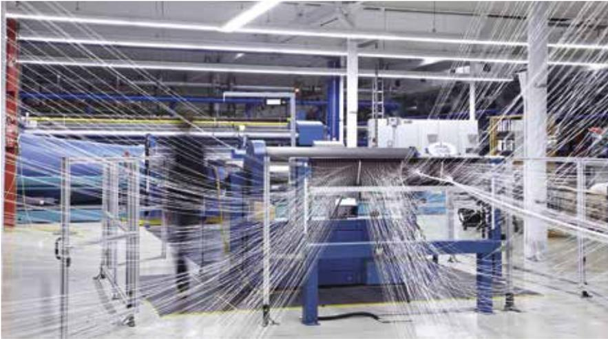
Das Herz der Produktion sind die Luftwebmaschinen, in denen mithilfe komplexer Technologien das auf die jeweilige Kundenanforderung spezialisierte Gewebe entsteht.
