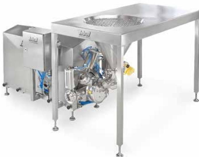
Die global eingesetzte Conti-TDS-Anlage besteht aus einem Basismodul, einem installierten Werkzeugkit sowie einem Pulvertisch und wird zur Herstellung von Milch-Desserts eingesetzt.
