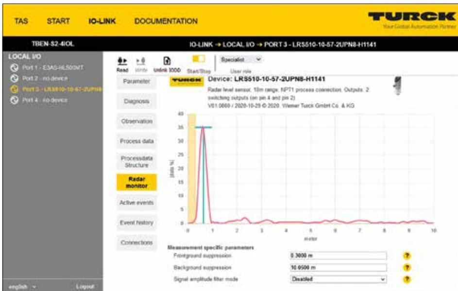
TAS Desktop: Der Radar Monitor erleichtert die Einrichtung der Sensoren durch Echtzeit-Visualisierung und Störsignal-Filtermöglichkeiten.
