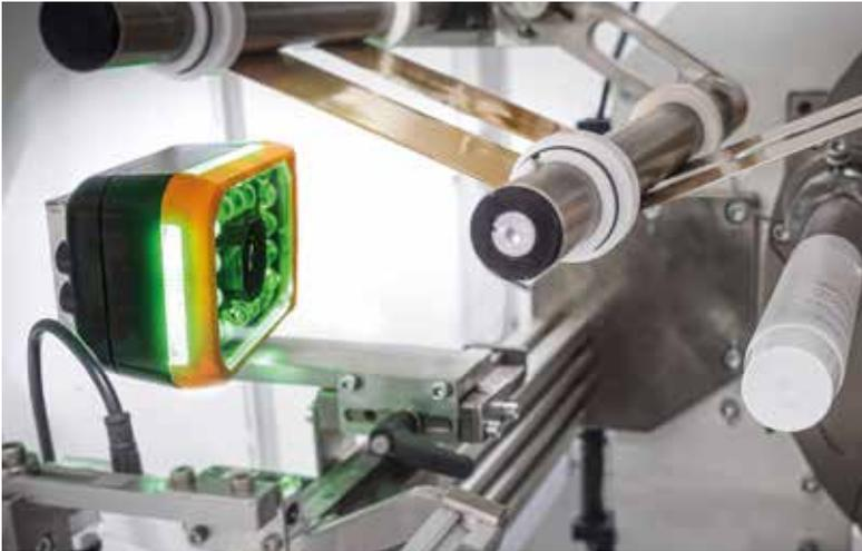
Die neue Smart Camera von B&R bringt KI direkt in den Maschinensteuerungskreislauf ein und ermöglicht so Echtzeit-Vision, dynamische Modellwechsel und eine bis zu 15-fach höhere Edge-Verarbeitungseffizienz.
