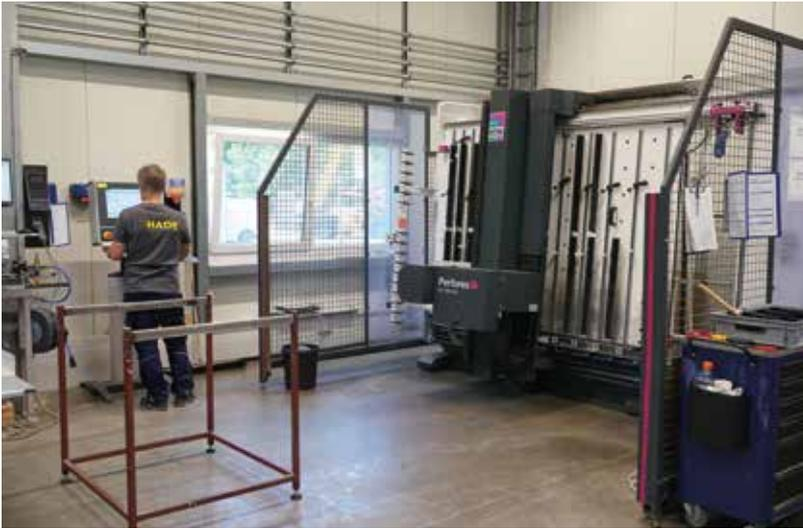
Mit einer Perforex von Rittal Automation Systems werden Schränke wie auch Stromschienen auf Basis der Eplan Daten bearbeitet.
