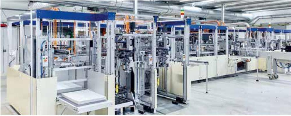
Die 15,5 m lange Gesamtanlage besteht aus der Maschine Fourcut zum Abzählen und Zuschneiden der Signaturbogen in einzelne Nutzen sowie aus der Wiro 500 für das Binden der Kalender.
