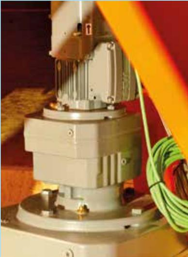
Der Stirnradgetriebemotor RF127 R77 DRL71 von SEW-Eurodrive greift über das Antriebsritzel in die Innenverzahnung der Kugeldrehverbindung ein. Somit entsteht eine Drehbewegung mit wenigen Umdrehungen pro Minute.
