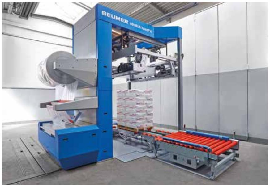
Mit einem Beumer stretch hood transportsicher verpackte Zementsäcke
