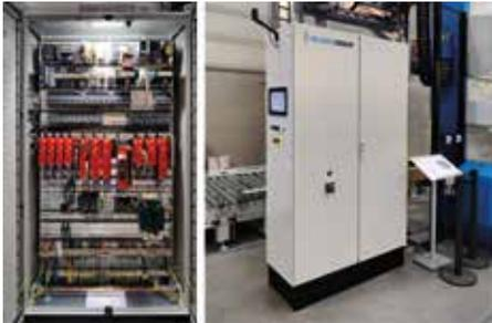
Energie, Gewicht und Platz sparen bei der Verdrahtung: Oben der Schaltschrank mit Montageplatte und nötigem Klimagerät, darunter der Schrank mit dem Airstream System. Beide mit identischer Bestückung.
