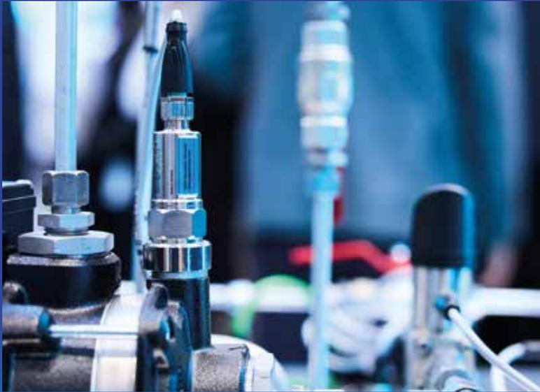
Ein 12-kHz-Schwingungssensor erfasst relevante Zustandsdaten.
