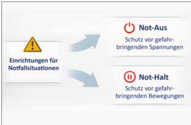
Unterschied zwischen Not-Halt- und Not-Aus-Schaltern
