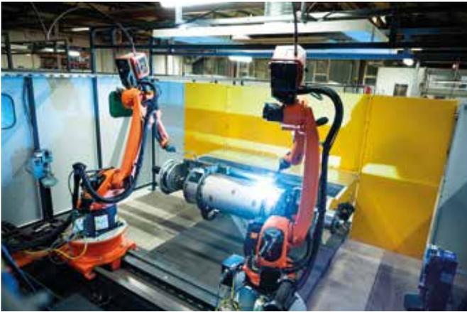
Auf der Linearschiene schweißen die zwei Schweißroboter KR Cybertech nano ARC von Kuka die Nähte der Ofen-Komponenten ab – präzise und effizient.
