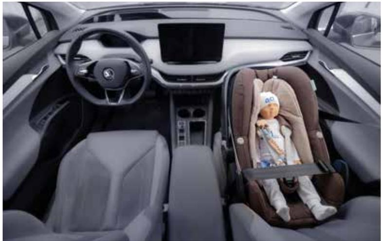
Der von 4activeSystems entwickelte Newborn-Dummy simuliert täuschend echt die Eigenschaften eines Säuglings. Mit seiner Hilfe wird getestet, ob CPD-Sensoren zuverlässig funktionieren, damit keine Kleinkinder im Auto vergessen werden.
