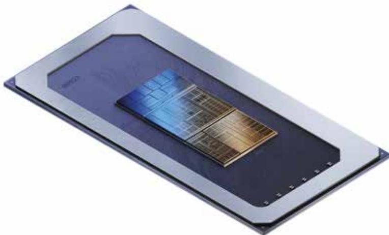
Intel-Core-Ultra-Prozessoren integrieren neben CPU und GPU eine dedizierte KI-Engine – die NPU – für energieeffiziente KI-Berechnungen.
