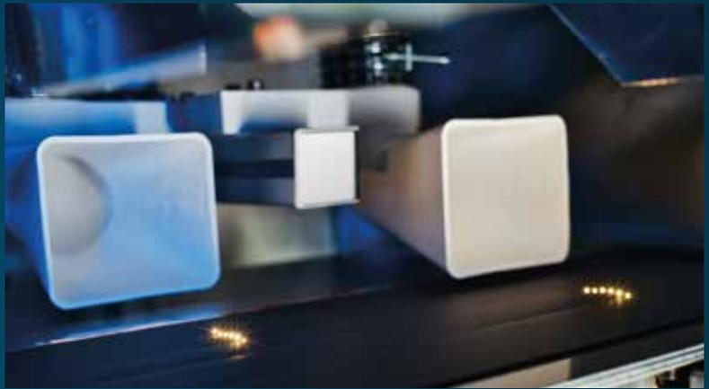
12 von 24 Teilstrahlen im Einsatz: Die Optik von Pulsar Photonics strukturiert das 300 mm breite Band der Batterieanode und verbessert so Leistungsdichte und Ladefähigkeit.
