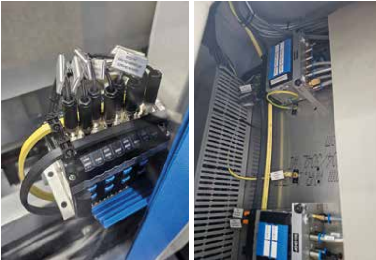
In den Maschinenkörpern der Schleifmaschinen von Schütte wird die komplette Anbindung der Peripherie über AS-Interface realisiert
