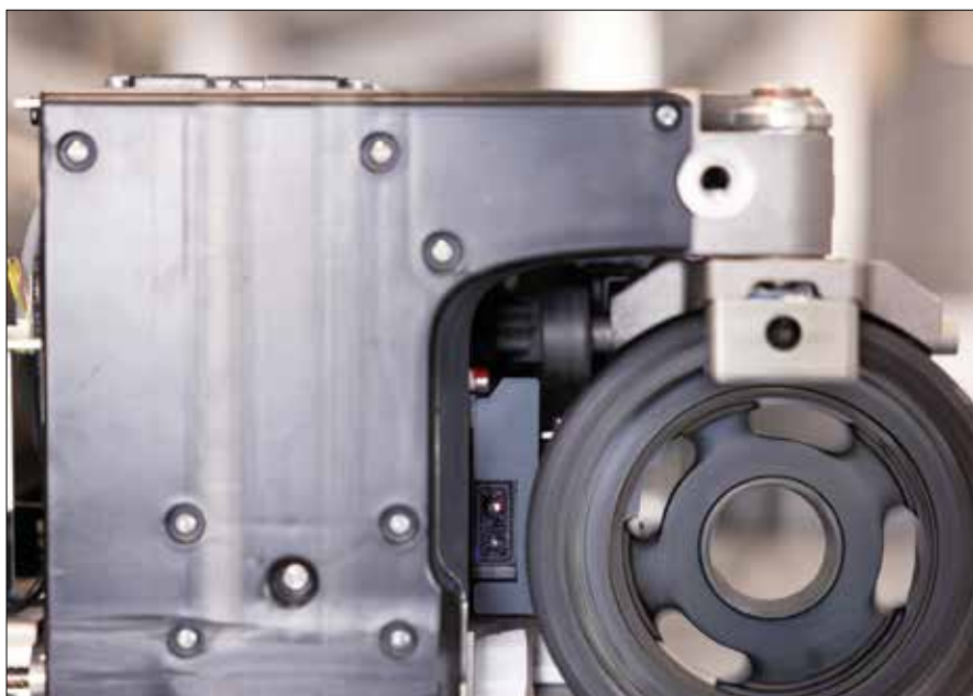
Seitlicher Blick auf den Transportshuttle mit dem Baumer Sensor OT300, der im Vorbeifahren Lagerabteile auf Belegung und Positionierung der Produkte abtastet.
