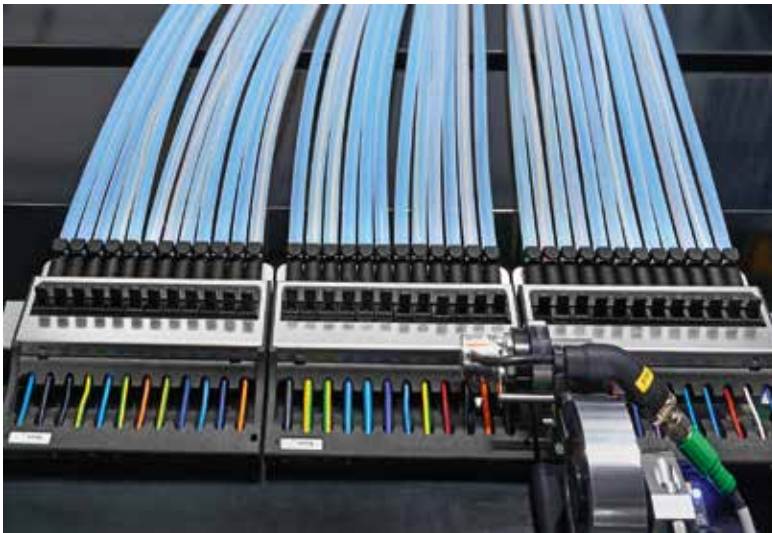
Mit dem Wire Terminal WT C von Rittal wird der Fertigungsprozess der Drahtkonfektionierung bis zum 10-fachen beschleunigt.
