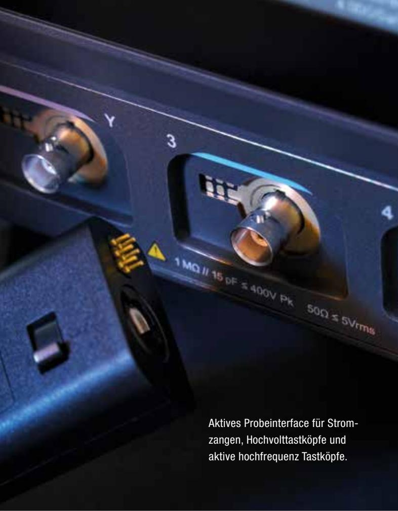
Aktives Probeinterface für Stromzangen, Hochvoltastköpfe und aktive hochfrequenz Tastköpfe.
