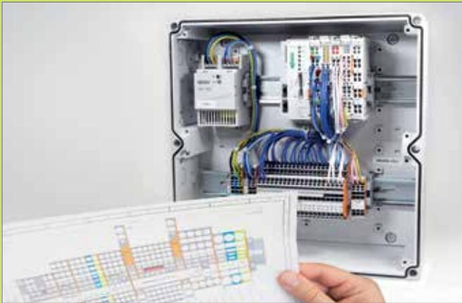
Für die Montage von Schaltkästen und -schränken liefert die WSCAD-Software korrekte Beschriftungsdaten zum Ausdrucken. In WSCAD eingeplante Wago-Klemmen lassen sich über den Smart Designer von Wago direkt aus der Anwendung heraus aufrufen und konfigurieren.
