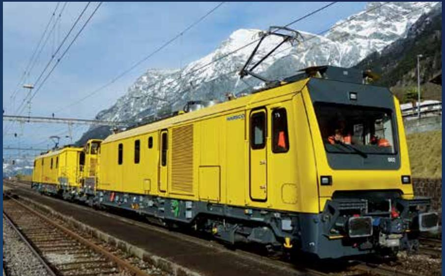
Die Erhaltungsfahrzeuge von Harsco lassen sich als spezialisierte Wartungszüge zusammensetzen, die teilweise drei- bis vierhundert Meter lang werden können. Alle Wagen können miteinander kommunizieren und sind mit automatischen Kupplungen verbunden.
