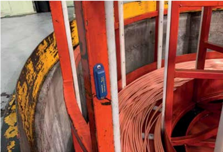
Der robuste UHF-Datenträger kann direkt am Metallrahmen montiert werden.
