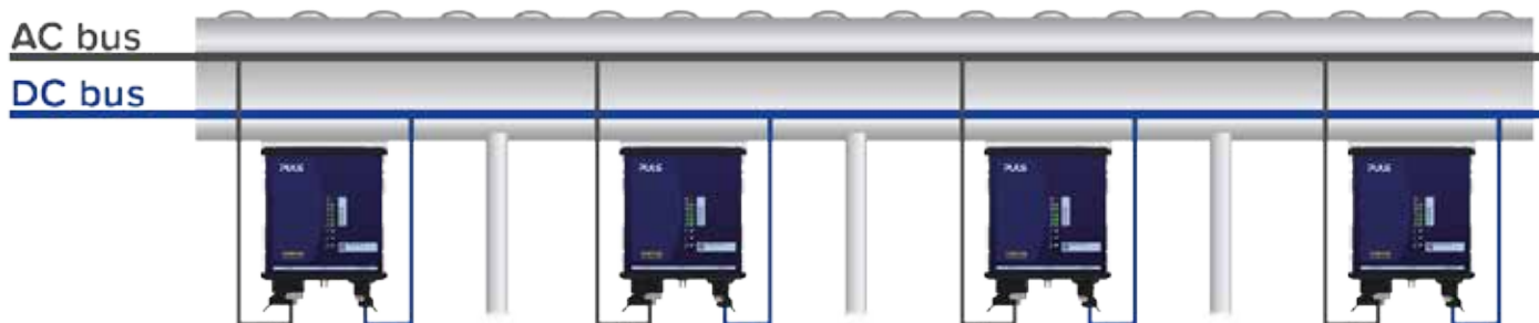
Grafik 3: Zur Leistungserhöhung oder Redundanz lassen sich die Geräte der FIEPOS Basic-Serie parallel schalten.
