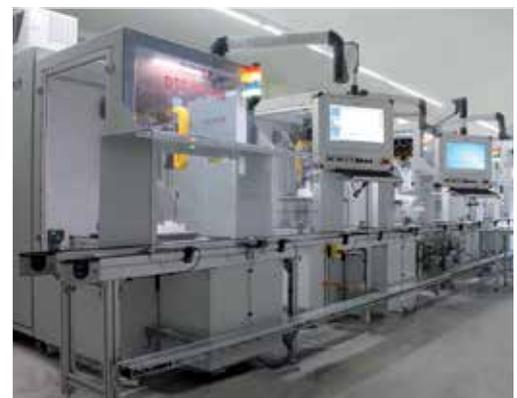
Testsystem für E-Motoren
