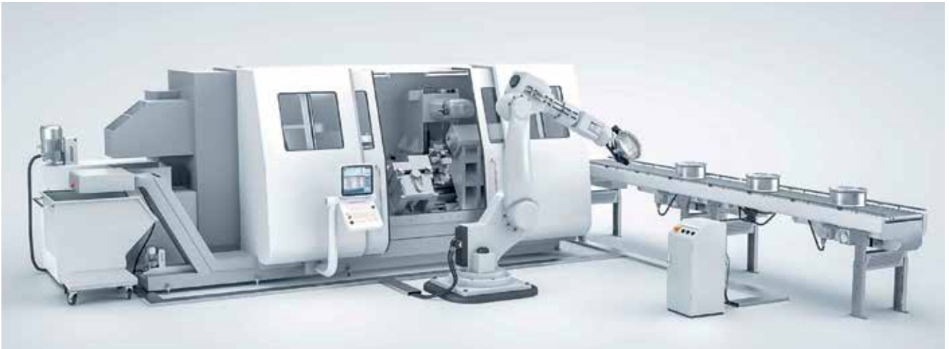
Werkzeugmaschine mit Key- und Add-On-Modulen als Teil einer Produktionslinie
