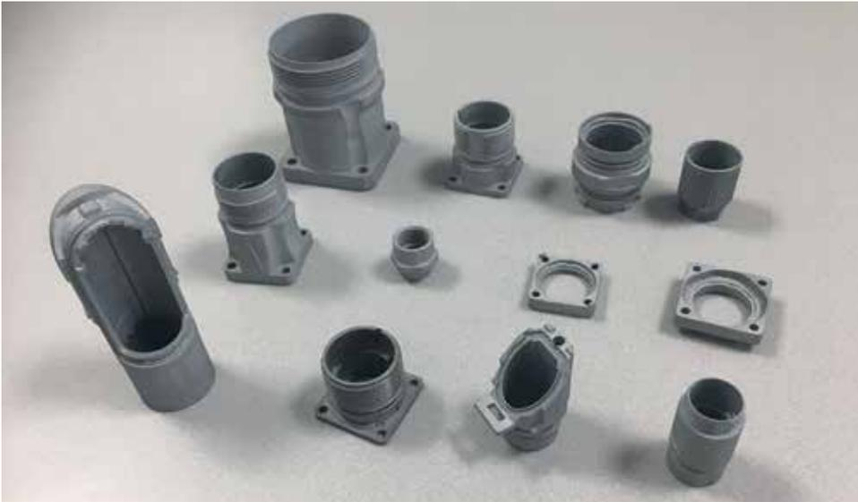
Prototypen und Serienbauteile aus dem Serienmaterial Zamak 5 werden bei Protiq über Nacht auf 3D-Druckern gefertigt.
