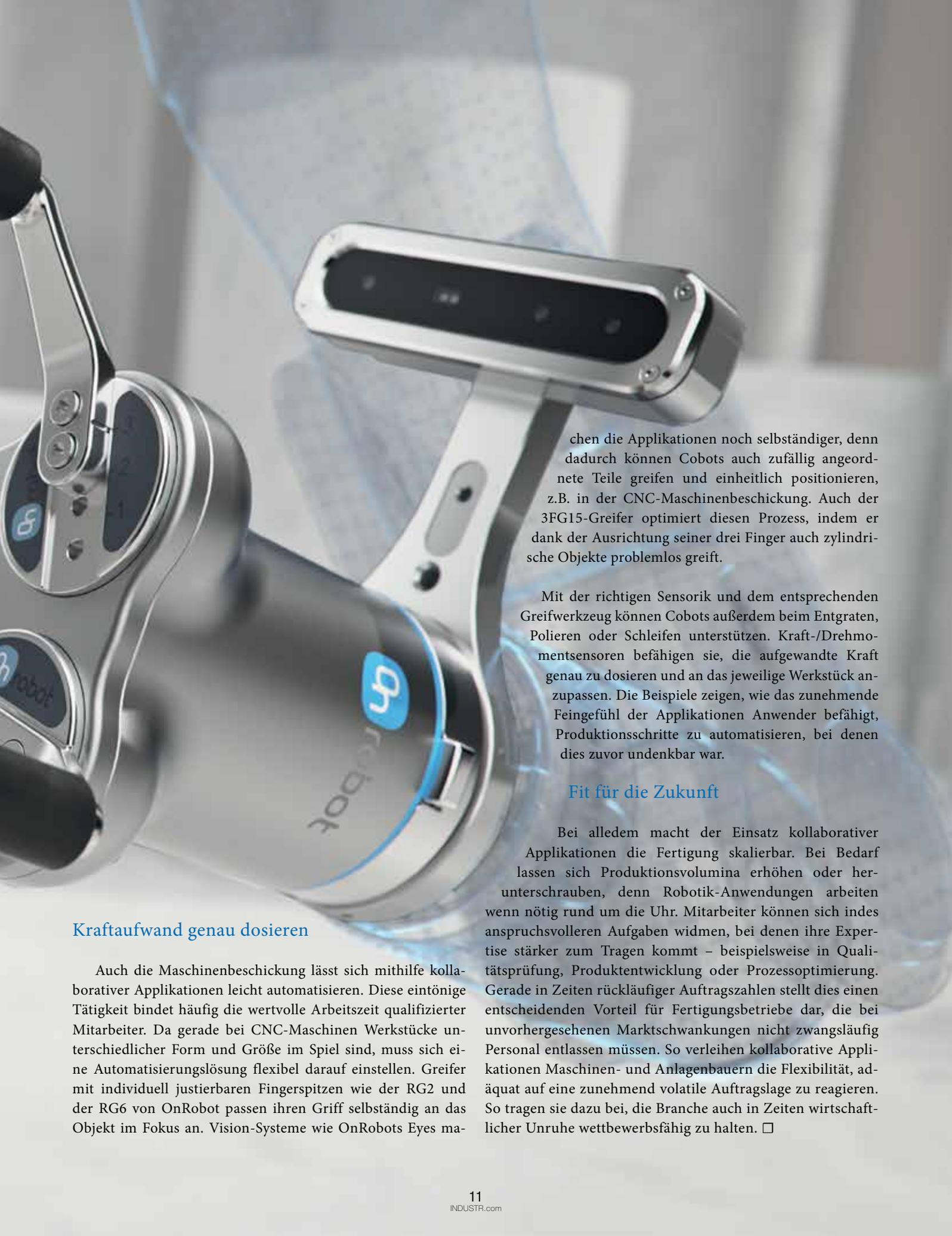
chen die Applikationen noch selbständiger, denn dadurch können Cobots auch zufällig angeordnete Teile greifen und einheitlich positionieren, z.B. in der CNC-Maschinenbeschickung. Auch der 3FG15-Greifer optimiert diesen Prozess, indem er dank der Ausrichtung seiner drei Finger auch zylindrische Objekte problemlos greift.
