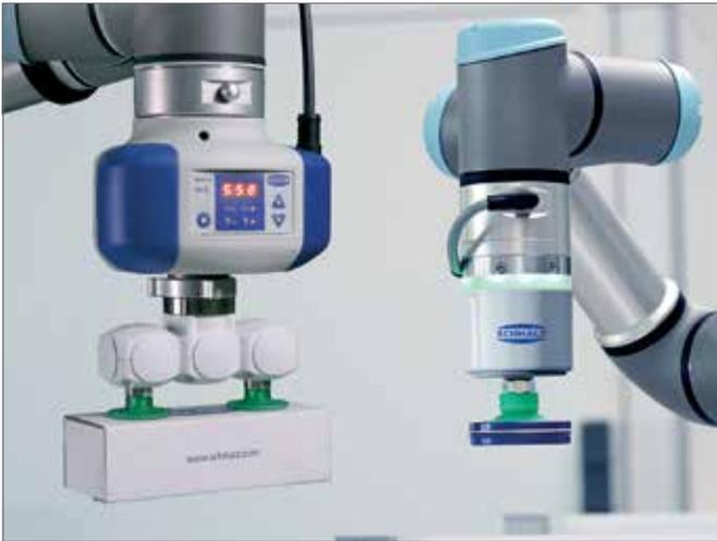
„Großer Bruder“ und „kleiner Bruder“: die elektrischen Vakuum-Erzeuger ECBPi und ECBPM wurden für mobile Robotik entwickelt.
