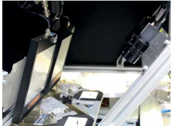
In der zweiten Prüfbox sind Kameras und Beleuchtung schräg angeordnet. Fehler auf der Oberfläche der Steckdosenplatten zeigen sich durch den Schattenwurf.
