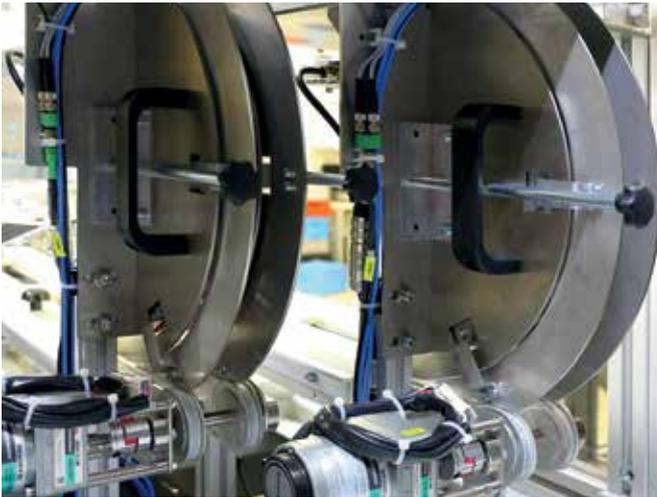
Zwei Wendeeinheiten drehen die Steckdosenplatten, damit auch die Rückseite kontrolliert werden kann.
