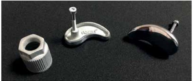
Die Oberflächenveredelung von 3D-gedruckten Zinkbauteilen ermöglicht den Einsatz im Sichtbereich, beispielsweise als Interieurbauteile im Auto.
