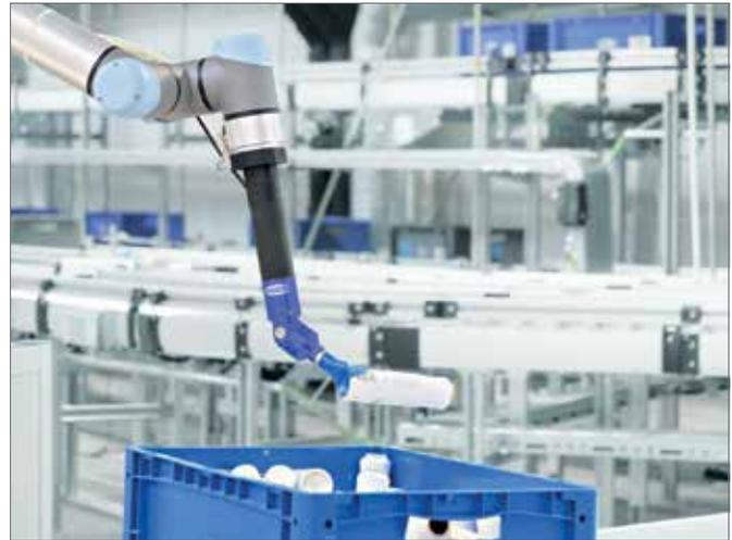
Der neue Sauggreifer SBPG greift Werkstücke auch direkt an Ecken und Kanten.
