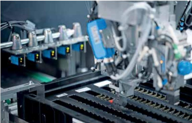
Smart Tasks im Einsatz: Die Sensoren erkennen die individuelle Belegung eines Werkstückträgers und teilen der Robotersteuerung direkt mit, auf welchen Steckplätzen sich Werkstücke befinden.
