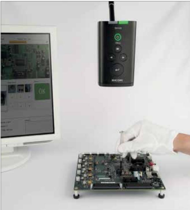
Leiterplattenbestückung mit dem „Human-Assistance“-Kamerasystem Ricoh SC-10.
