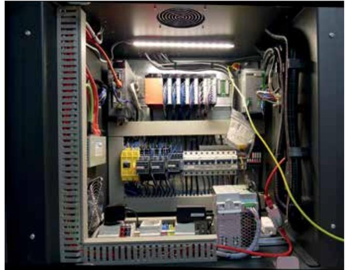
Kompakte Bauweisen und geringe Verlustleistungen der Automatisierungskomponenten von Mitsubishi Electric ermöglichen eine direkte Unterbringung in der Maschine – ohne Schaltschrank.
