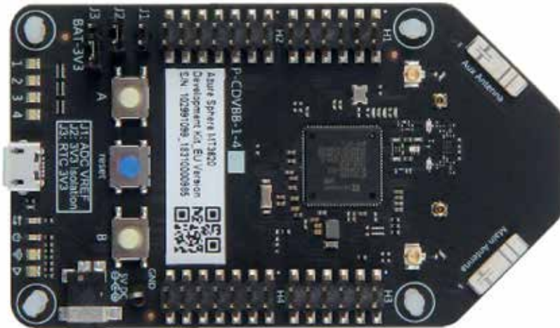
Das Azure Sphere Developmentkit MT3620 bietet einen einfachen Einstieg in die Welt des Internet of Things und setzt dafür auf Microsofts Azure Sphere.
