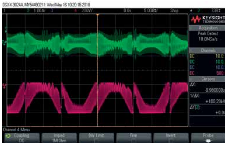
Gleichtaktstörstrom (grün) und Gleichtaktstörspannung (rot) beim PFC Wandler bei 1000 Watt Volllast und bei einer Netzspannung von 230 VAC.
