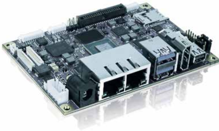
Das Kontron-pITX-iMX8M im kleinsten SBC-Formfaktor Pico-ITX: Es ist bestückt mit NXP 2- oder 4-Kern-CPU's auf Basis der Arm Cortex-A53-Architektur mit bis zu 1,5 GHz.
