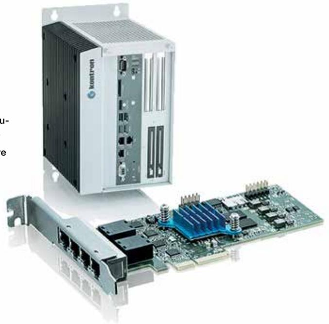
GbE-Ports und eine PCIe-Anbindung an den Host-Computer. Zukünftige Erweiterungen der TSN-Spezifikation lassen sich durch Software-Updates im FPGA integrieren.
