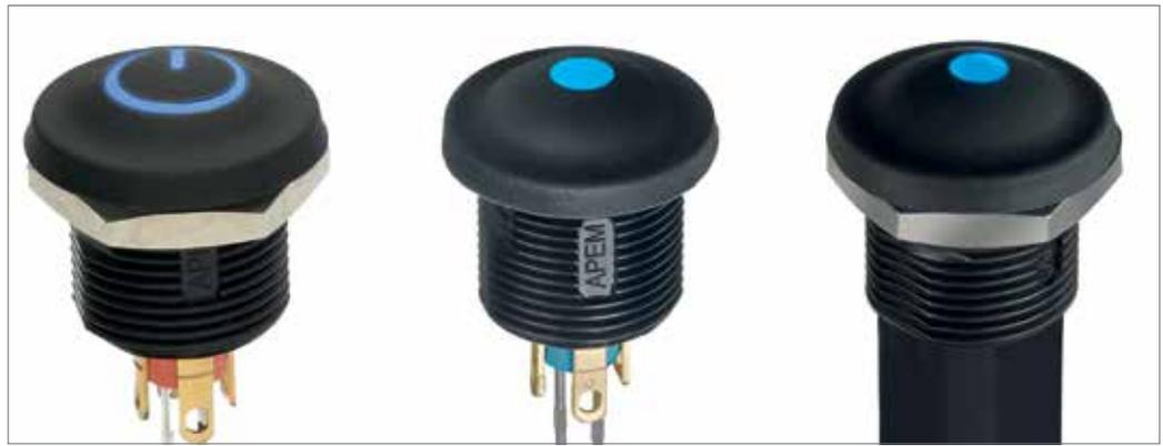
Nur 12 mm im Durchmesser, aber eine breite Palette an Gestaltungsmöglichkeiten: Die Taster der Serie IX bieten eine ganze Reihe unterschiedlicher Betätigerfarben, Leuchtmarkierungen und Beschriftungssymbole. Zusätzlich sorgt die flexible Elastomer-Kappe für eine Frontplattenabdichtung bis zu IP69K.
