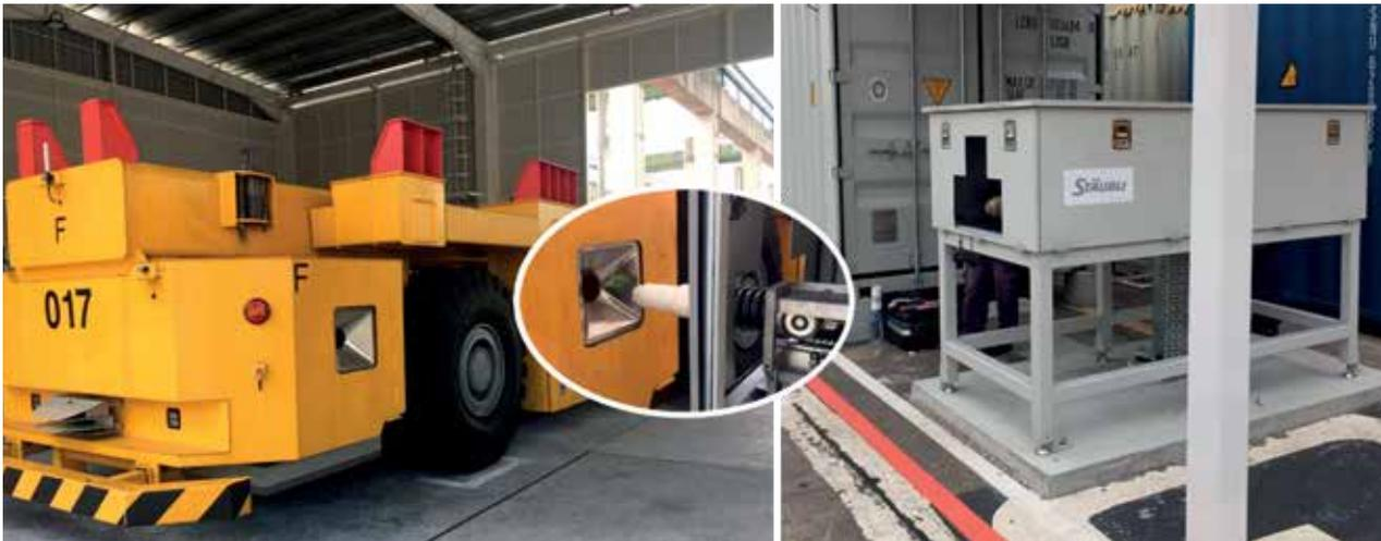
Mit Hilfe von Schnellladesystemen können die Stillstandszeiten von elektrischen Transportfahrzeugen deutlich reduziert werden.
