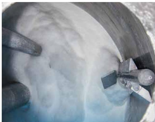
misst es sehr zuverlässig, trotz Ablagerungen, Schaum, Einbauten und unabhängig von Dichteschwankungen.
