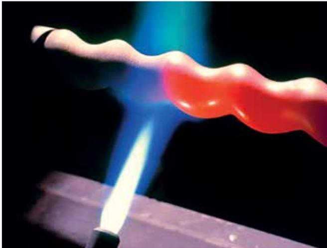
Pulverflammspritzen eignet sich besonders zur Reparaturbeschichtung mit Metallen.
