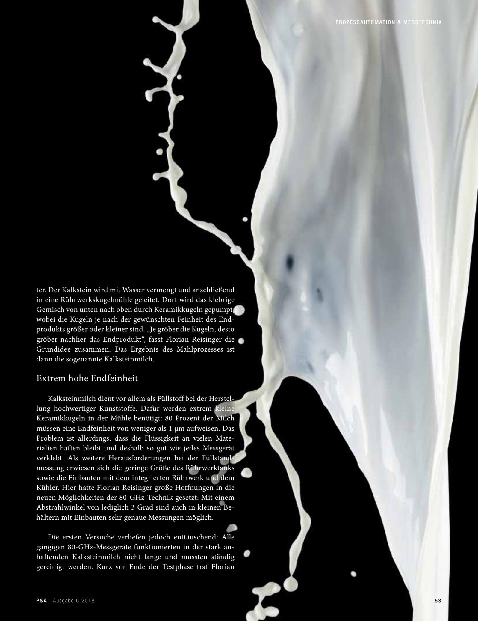
ter. Der Kalkstein wird mit Wasser vermengt und anschließend in eine Rührwerkskugelmühle geleitet. Dort wird das klebrige Gemisch von unten nach oben durch Keramikugeln gepumpt, wobei die Kugeln je nach der gewünschten Feinheit des Endprodukts größer oder kleiner sind. „Je gröber die Kugeln, desto gröber nachher das Endprodukt“, fasst Florian Reisinger die Grundidee zusammen. Das Ergebnis des Mahlprozesses ist dann die sogenannte Kalksteinmilch.
