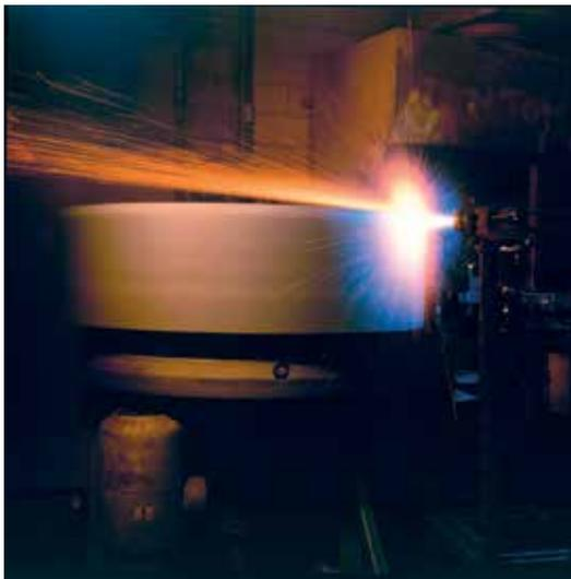
Beim Lichtbogenspritzen mit elektrischer Energie entstehen sehr belastbare, fest anhaftende, hochtemperatur- und oxidationsresistente Oberflächen.
