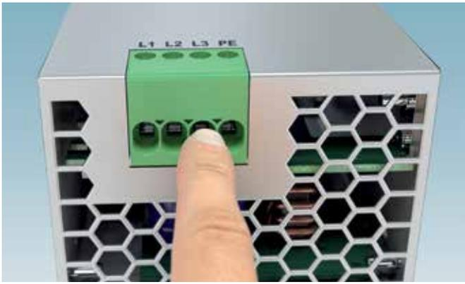
Für hohe Spannungen: Der erweiterte Berührschutz nach IEC/UL 61800-5-1 erlaubt den Einsatz ohne zusätzliche Abdeckung.
