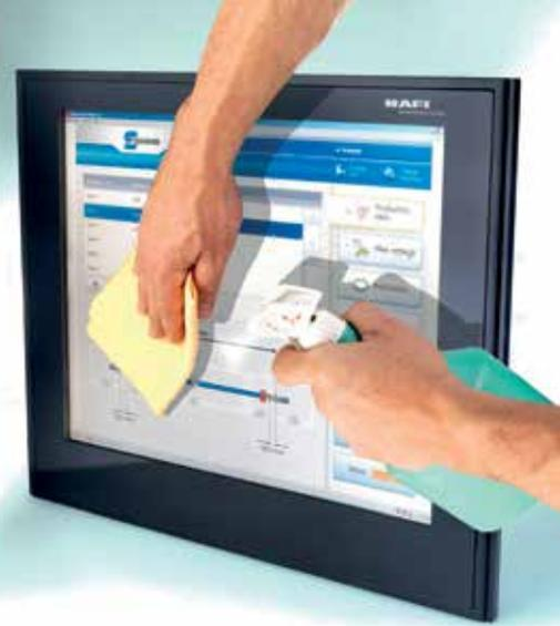
dafür sind Luftspalte, die bedingt durch die Fertigung zwischen der Frontplatte, dem PCAP-Touch-Sensor und dem Display entstehen. Lichteinfall ruft an den Grenzschichten der transparenten Medien Lichtreflexionen hervor, die sich mit dem angezeigten Bild überlagern. In der Folge können Sonneneinstrahlung oder helles Tageslicht die Bildkontraste verschlechtern und damit die Ablesbarkeit entweder einschränken oder gar unmöglich machen.
