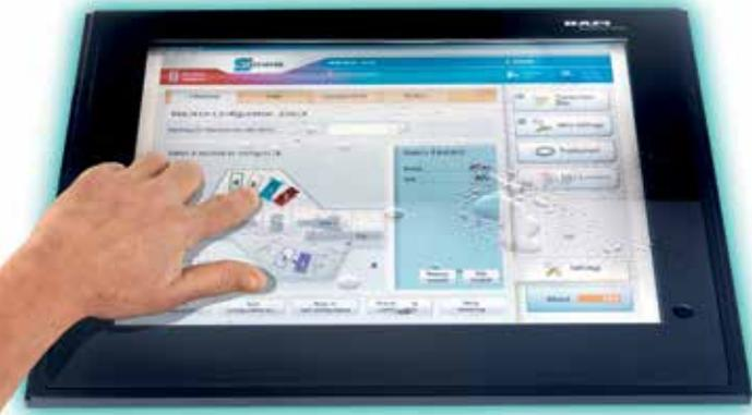
Nässe auf dem Glasscape-Touchscreen führt zu keinen Einschränkungen der Funktionalität, da die Maxtouch-Controller das Wasser erkennen und die dadurch ausgelöste Fehleingabe unterdrücken.
