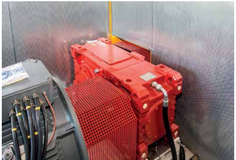
Das SEW-Getriebe der Bau- reihe X ist kompakt an den Motor angeflanscht.
