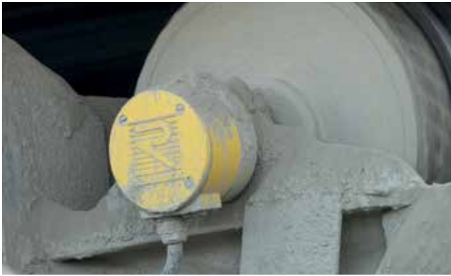
Die Rulmeca-Trommelmotoren – hier im Outdoor-Einsatz bei einer Baumaschine – müssen enorme mechanische Beanspruchungen aushalten. Eine robuste Konstruktion und der hohe Schutzgrad mit mindestens IP 66 sind daher zwingend notwendig.
