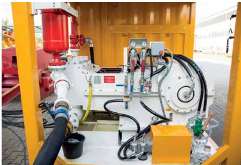
Die Suspensionspumpen der Bohranlagen sind so groß, dass sie mitsamt ihrem Antrieb einen eigenen Container benötigen.
