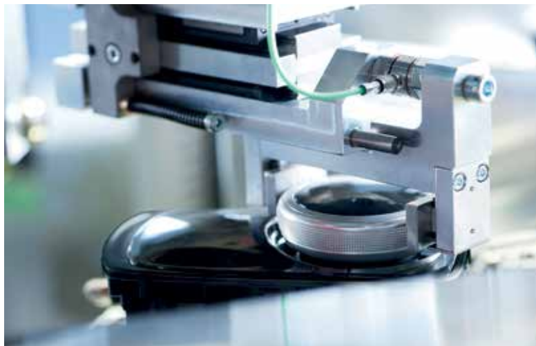
Für die Überprüfung der horizontalen Kippkraft kommt ein Kistler-Sensor vom Typ 9311 zum Einsatz. Da bei der horizontalen Kippbewegung Querkräfte wirken, müssen diese mittels mechanischer Ausgleichselemente kompensiert werden.
