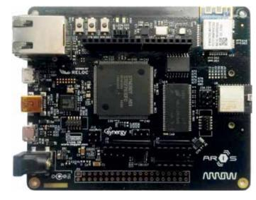
In 2016 hat Arrow das ARIS Board vorgestellt, eine einsatzbereite Internet of Things (IoT) Hardware- und Software-Plattform, die es Anwendern ermöglicht, IoT-Anwendungen mithilfe des Renesas Synergy Entwicklungs-Frameworks rasch zu realisieren. Die Plattform unterstützt Entwickler dabei, IoT Designs mit einer Kombination aus Hardware und Software schneller zu erstellen, und leistet damit einen Beitrag zu Innovation und Produktdifferenzierung.
