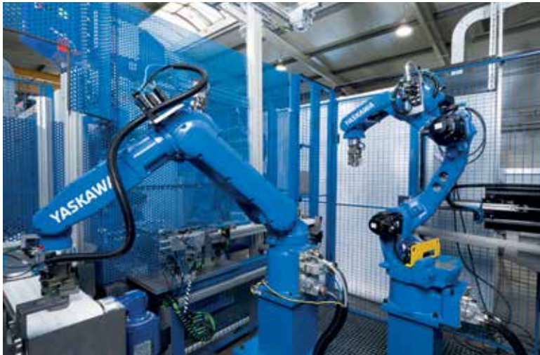
Die Motoman-Handlingroboter der MH-Reihe sind für vielfältige Automatisierungsaufgaben rund um Handling, Montage und Beschickung prädestiniert. Die Reihe umfasst Modelle mit 5 bis 600 kg Tragkraft.
