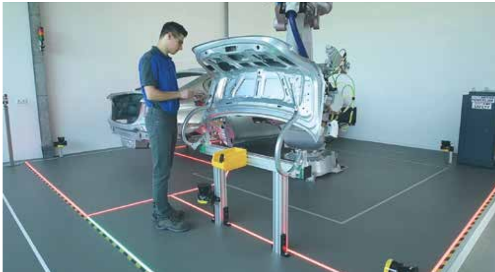
Der Roboter fixiert das Werkstück und ist im sicheren Halt, während die Scharniere manuell befestigt werden.
