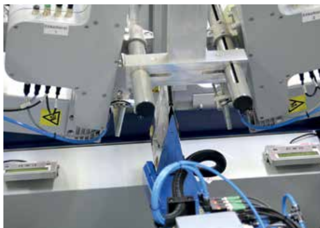
Ganz ohne Berührung bringen die kompakten Alpha-Etikettensponder auf der Beutelvorder- und -rückseite ein Etikett an.
