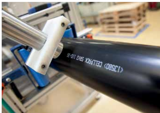
Direkt nach der Herstellung bekommen die Schläuche von einem Linx-Drucker die wichtigsten Angaben verpasst.
