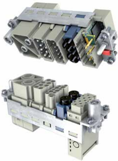
Modulare Steckverbinder machen Maschinen und Anlagen flexibler für Umrüstung und Erweiterung. Das Han-ID-Modul (rechts oben im Bild) ist zu Demonstrationszwecken „aufgeschnitten“: Die Darstellung zeigt, wie die kleine Speichereinheit in dem Isolierkörper gelagert ist.
