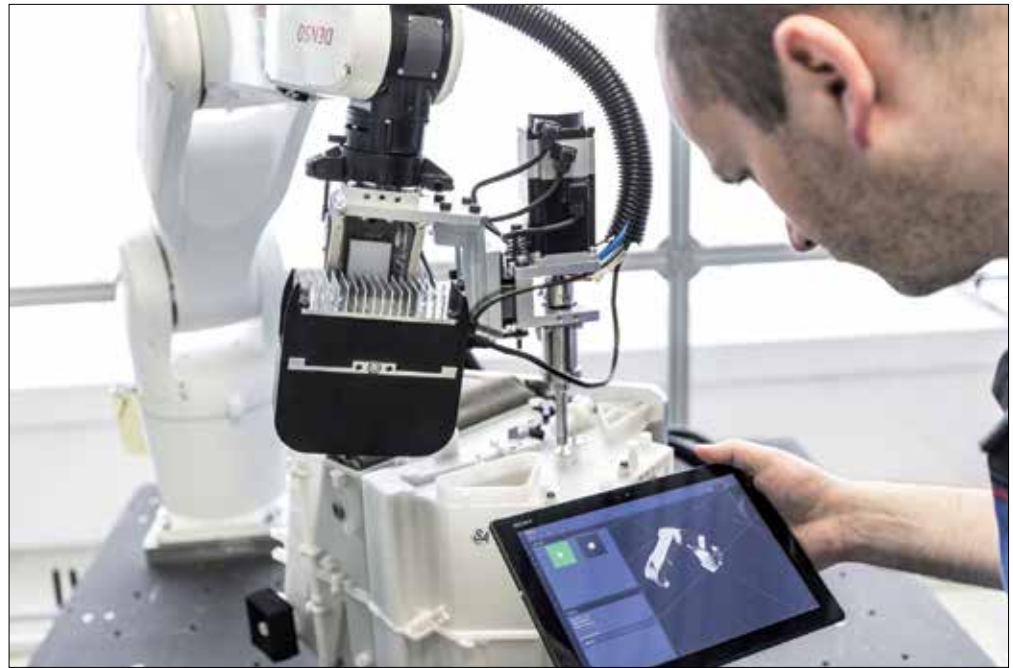
Die Software drag&bot bietet eine neue, intuitive Form der Roboterprogrammierung.
