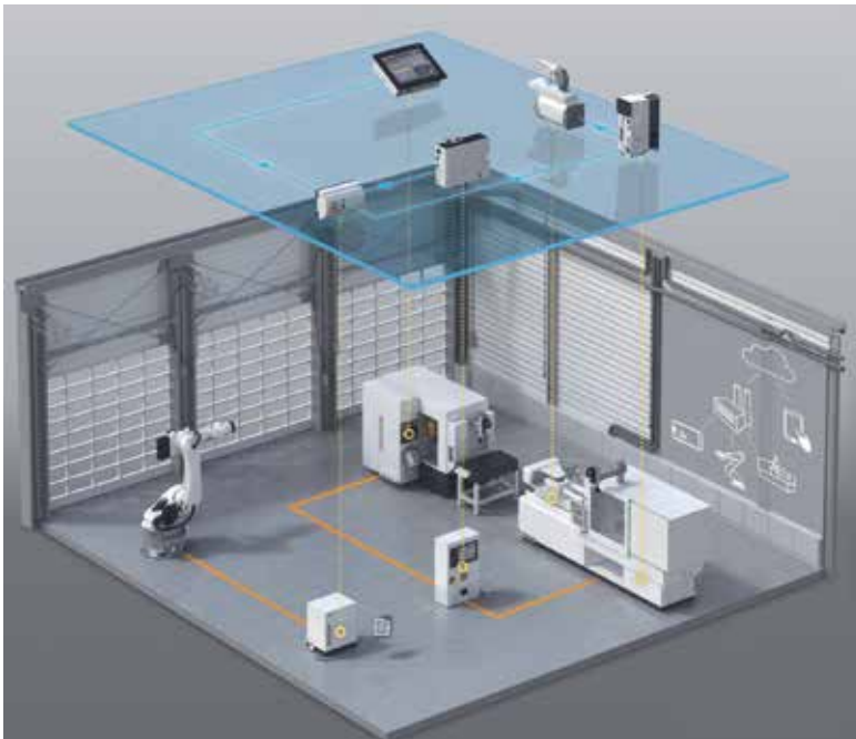
Zur Digitalisierung der Fabrik ist es notwendig, verschiedene Ebenen der Automatisierungspyramide eines heterogenen Maschinenparks an IT-Systeme anzubinden.
