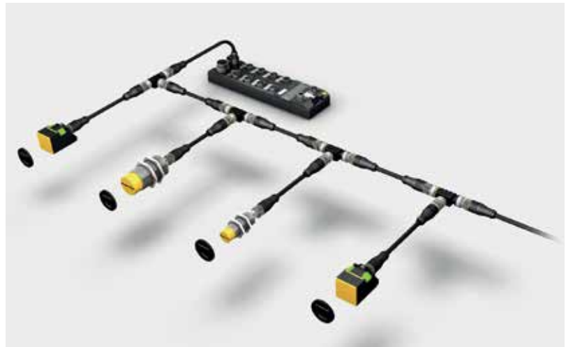
Im Bus-Modus können bis zu 32 Schreib-Lese-Köpfe an einem Interface angebunden werden.
