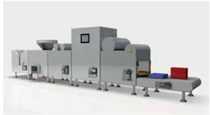
Kompakte Steuerungen in IP67 können Maschinenmodule komplett autark steuern.
