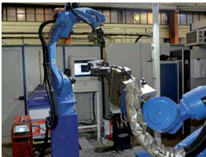
Beim vorrichtungslosen Schweißen führt ein Roboter das Werkstück, während der andere das Fügen übernimmt.
