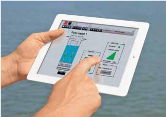
Eine plattformunabhängige Informationsverteilung setzt einen mobilen Zugriff per Webbrowser mit sicherer Kommunikationsverbindung auf das ausgelagerte Leitsystem voraus.
