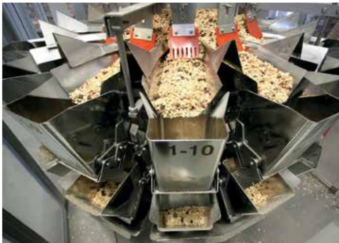
Sensible Gewichtssensoren sorgen für einen gleichmäßigen Produktfluss bei Mehrkopfwagen wie der Ishida CCW-RS.
