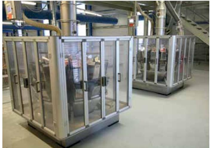
Wie viele Verpackungen pro Minute gefüllt werden können, hängt stark von der Fallgeschwindigkeit der Cerealien ab. Um die Menge zu erhöhen, bietet sich der Einsatz mehrerer Mehrkopfwaagen an.
