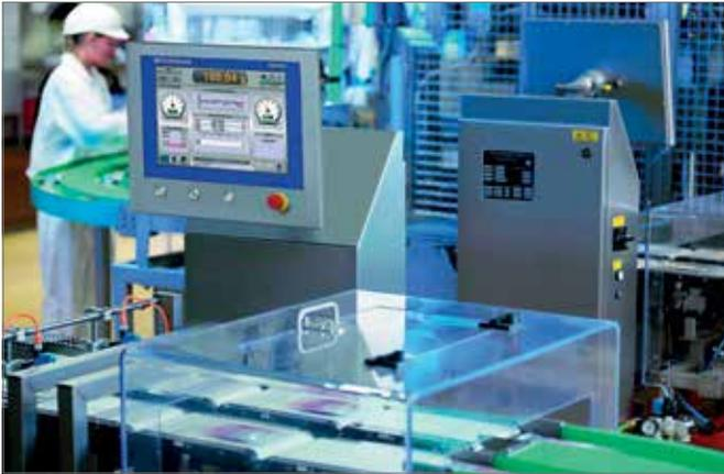
Dynamische Kontrollwaagen erfassen auch Qualitätskennzahlen, die Aufschluss über die Effizienz der Linie geben.
