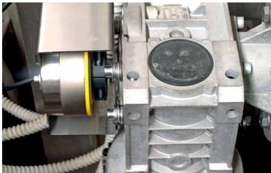
An den Riemenrollen erfasst der inkrementelle Drehgeber QR24 die Drehbewegung, die Impulszahl kann der Kunde selbst einstellen.
