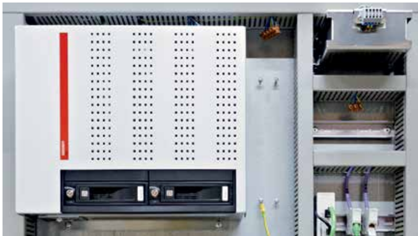
Die übergeordnete Steuerung und Überwachung der gesamten Liso-core-Fertigungsanlage übernimmt ein Schaltschrank-PC C6650 mit Multicore-Prozessor.
