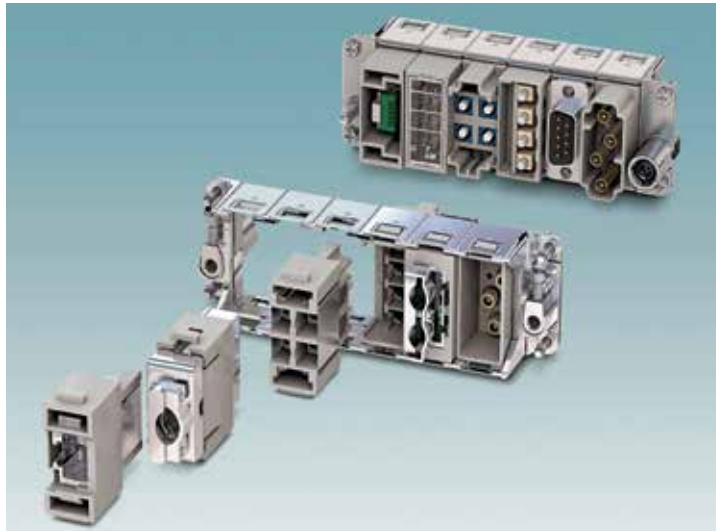
Der Snap-In-Rahmen erlaubt die Kombination von bis zu sechs Modulen. Ein versehentliches Verrutschen der Module ist ausgeschlossen.
