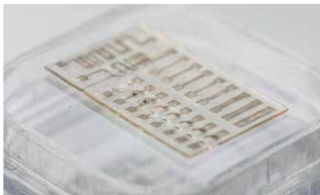
Auch filigrane Multimaterialstrukturen lassen sich additiv erzeugen. Durch hybride Verfahren können sogar elektronische Bauelemente integriert werden.
