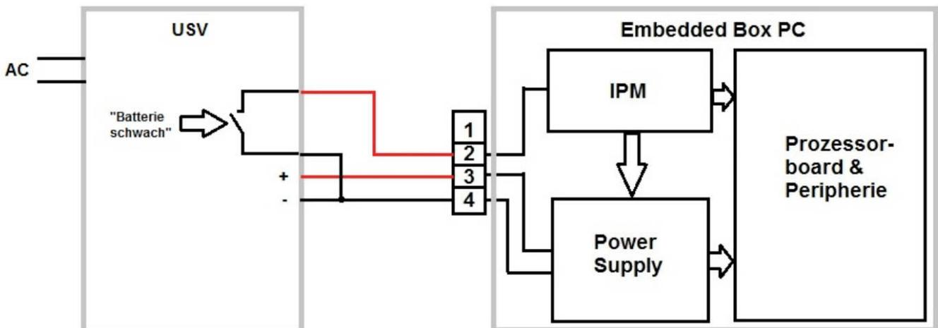
Der Embedded Box PC ist gemäß Manual auf den Power Fail Mode zu konfigurieren (Kodierschalter S12 auf Position 2, Kodierschalter S14 auf Position 0). Um im Falle der ungenügenden Versorgung durch die unterbrechungsfreie Stromversorgung das Power Fail auszulösen, muß das Signal an Pin 2 auf Low gesetzt bzw. müssen Pin 2 und Pin 4 gebrückt werden.
