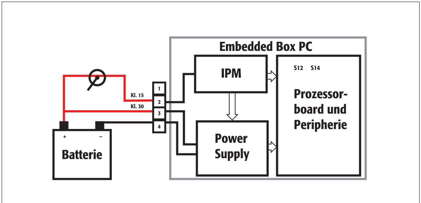
Wird ein Embedded Computer in einem Fahrzeug eingesetzt, wird dieser in der Regel nur während der Betriebsstunden des Fahrzeugs benötigt. Außerhalb dieser Zeit ist der Embedded Computer im Standby-Betrieb und entnimmt der Fahrzeugbatterie nur minimal Strom. Eine Tiefenentladung der Fahrzeugbatterie wird so verhindert.
