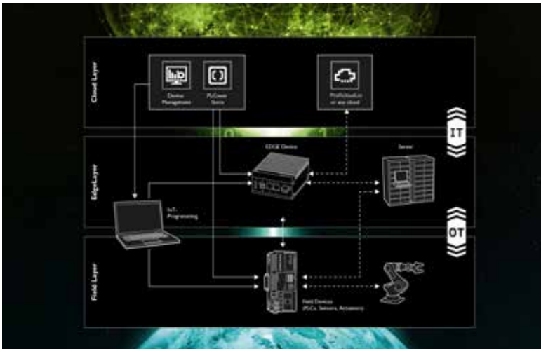
Edge-Computing mit der Virtual PLCnext Control: Echtzeit-Datenverarbeitung für mehr Effizienz und kürzere Latenzzeiten.
