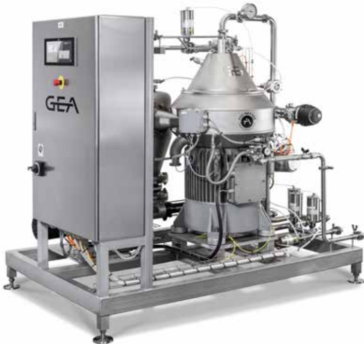
Von GEA für Craft-Brauereien entwickelt: Der effiziente „plug & win i Separator“.
